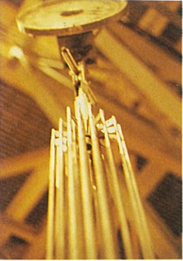
拆箱後的控制棒必先稱重。
