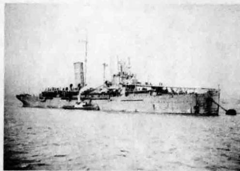
下水时间：1893年 排水量：18000吨 船员数：600 速度：22节 主要武器：6门119毫米大炮
