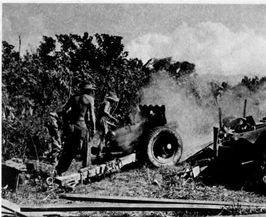
↑英国炮兵在缅甸战斗中使用的是—种94毫米驮载榴弹炮。自第一次世界大战以来，这种炮弹得到了装备改进，可以发射9千克的炮弹。
