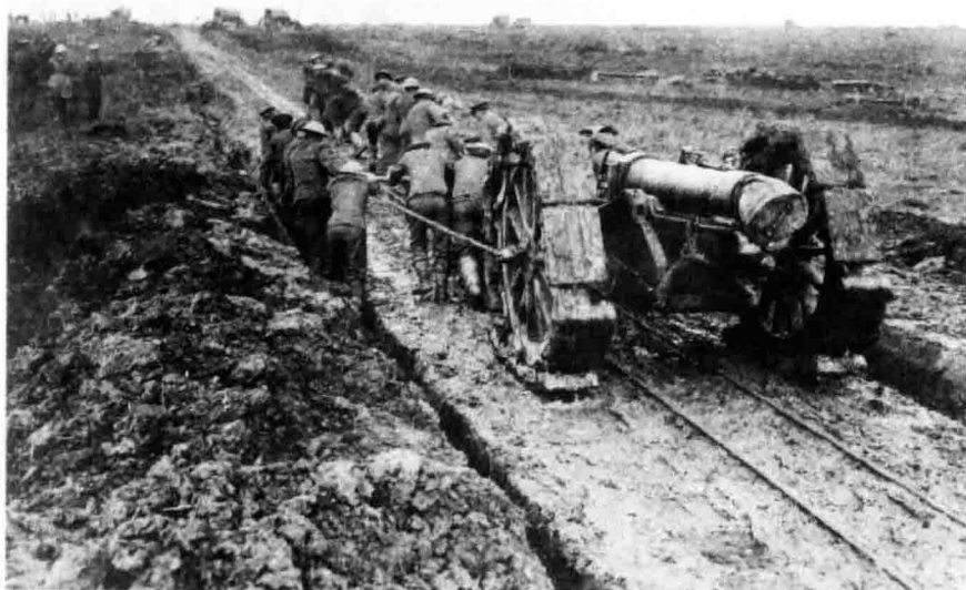
↑英军正将一门150毫米口径的榴弹炮拖上索姆河战场。为了防止开火时的后坐力让大炮陷入软泥之中，士兵们给这门大炮的轮子绑了很宽的“履带”来减小压强。
