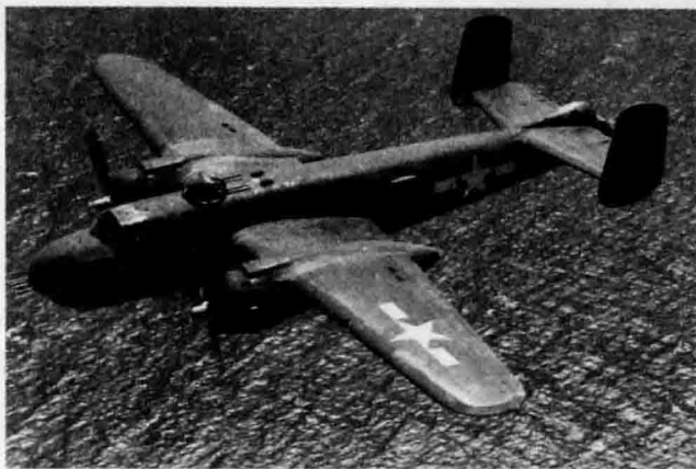
↑一架 B-25H “米切尔”在飞行之中。这是“米切尔”攻击机不同款式中的一种，其机身前端要比釉面的轰炸机外壳更加坚硬一些。这架战机配备着 8 挺向前开火的机关枪和一门 75 毫米的加农炮。
