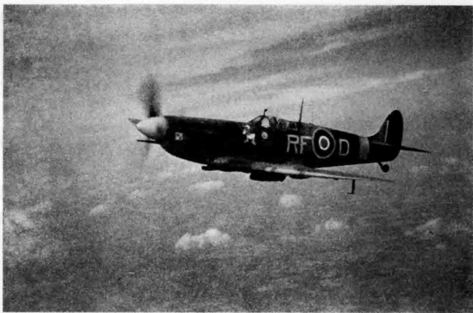
↑这是一架配有加农炮的喷火 5B 战斗机，其专属于波兰的 303 空军中队，在 1942 年正式奔赴战场。
