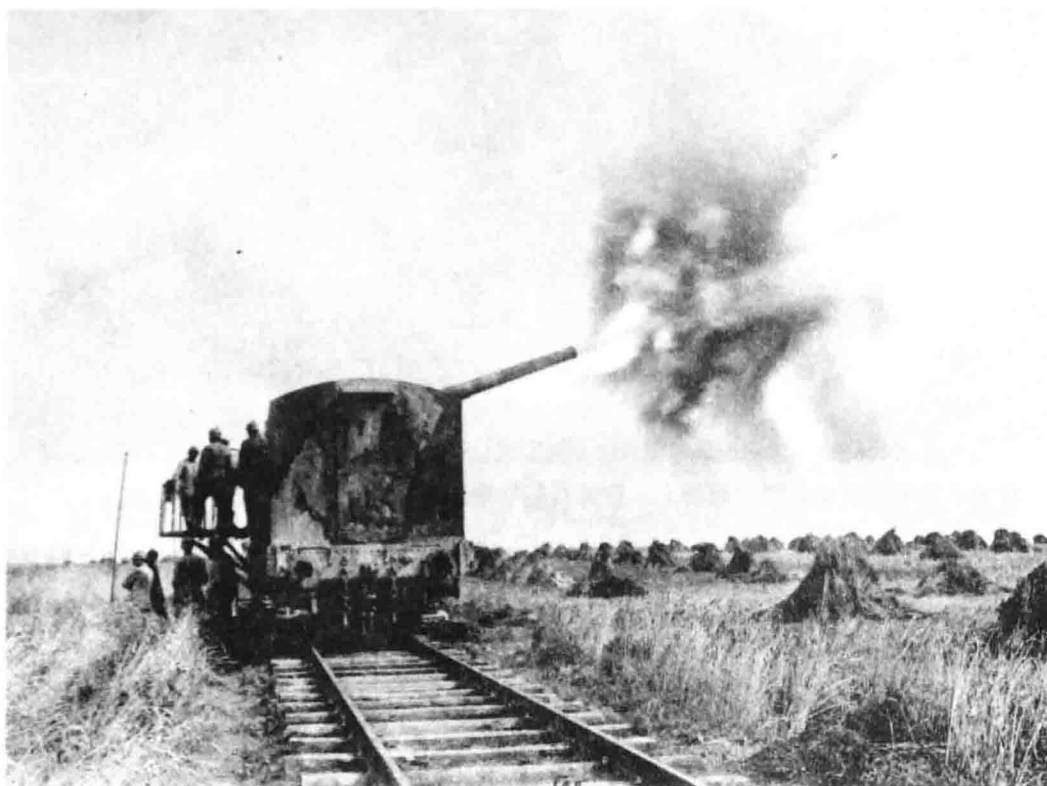
↑正如英德两国一样，法国也采用了轨道炮。图为一门 155 毫米口径的简易轨道炮正向远处的德军开火。
