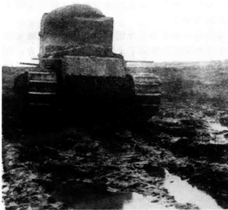
↑图为马克A型轻型战车。英军研发这种战车，是为了能够用一种快速移动的中型坦克扩大对敌方战线的突破效果。但比较让人失望的是，其时速只能达到13千米。
