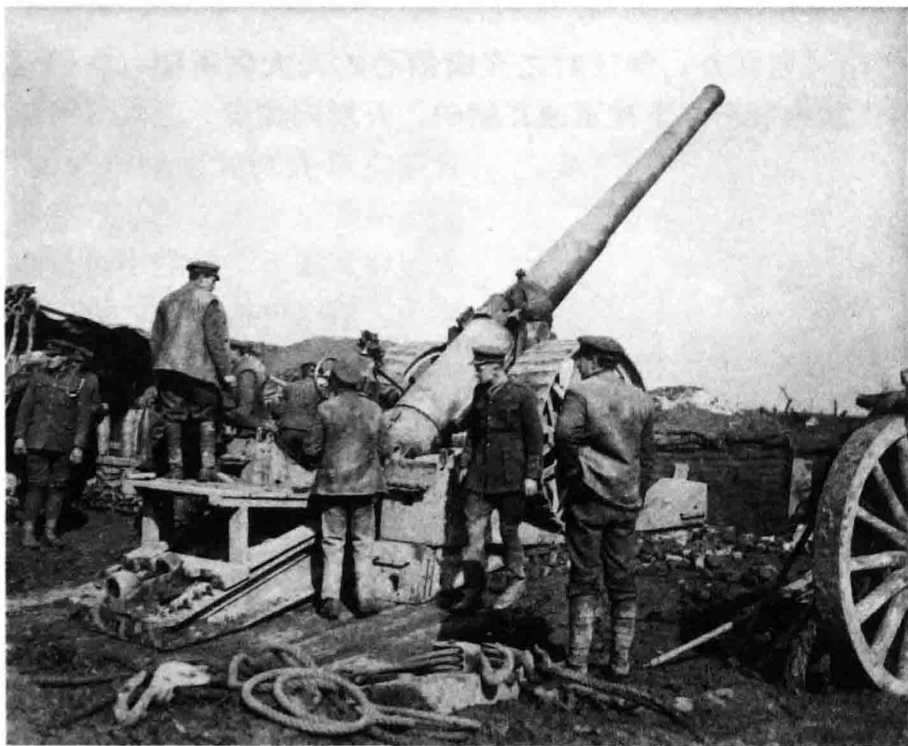
↑1917年，英国在西线战场设置的一门152毫米大炮。这个武器可以打出45千克的炮弹，射程达12500米。
