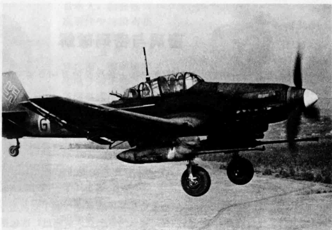
↑这是一架容克 87G 斯图卡飞机，配备了 37 毫米的反坦克加农炮。
