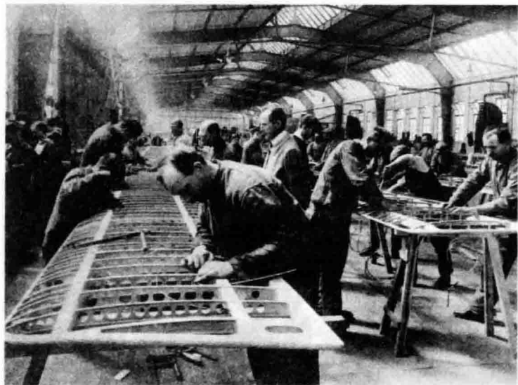
↑德国的投弹攻击使得协约国对战斗机的需求猛增。图为英国工人正在装配战斗机的机翼。
