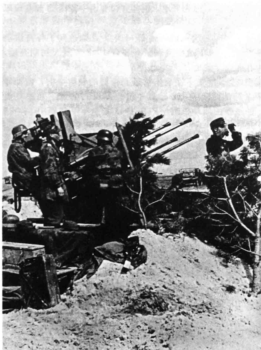
↑ 1944 年，在法国北部地区，这是一架德国 Flakvierling 四联 20 毫米 Flak 38 型高射炮。
