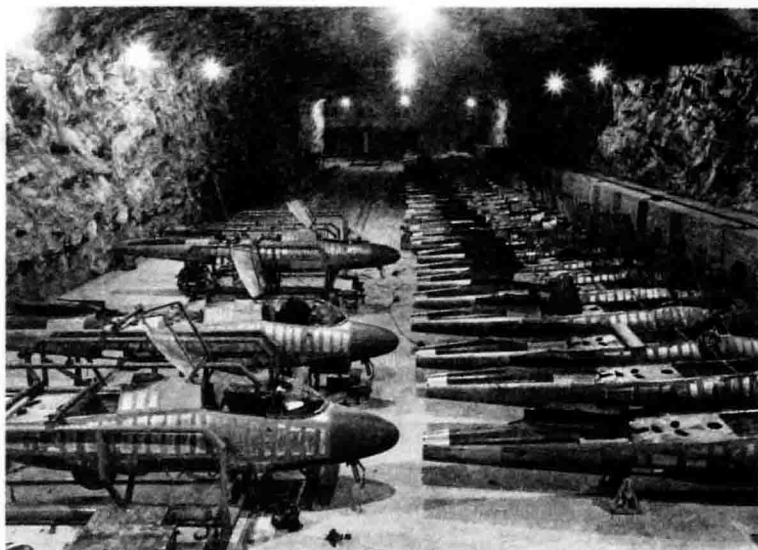
↑到 1945 年，盟军的空中优势已经迫使很多德国工厂都转入地下生产。图中这些亨克尔 162 式战斗机是在一个岩盐矿坑中被建造出来的。
