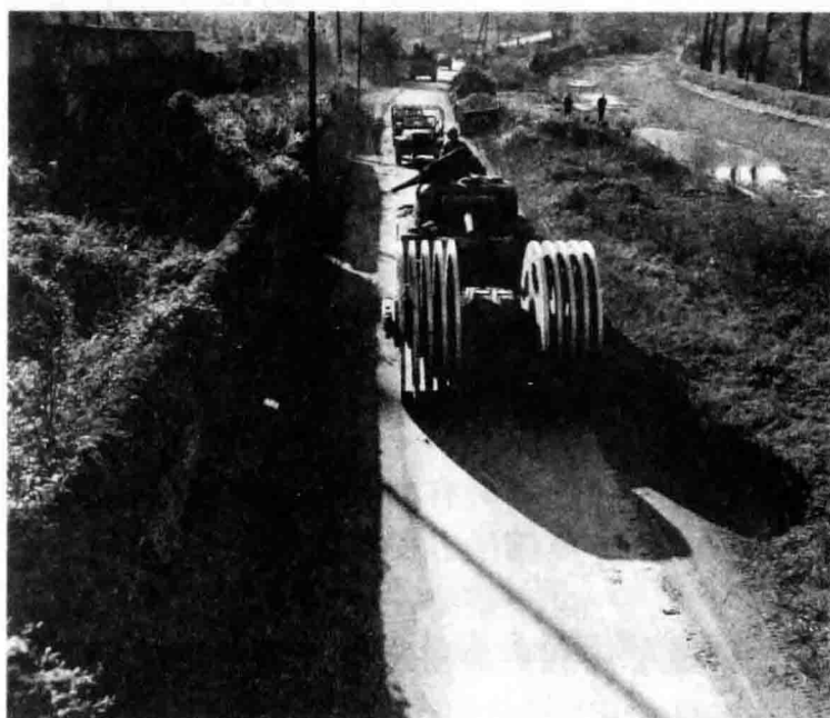
↑1944年，一辆美国T1型地雷引爆装甲车出现在法国境内。这辆重达18吨的扫雷滚轮车可以在谢尔曼坦克前方推进，时速是8千米每小时。
