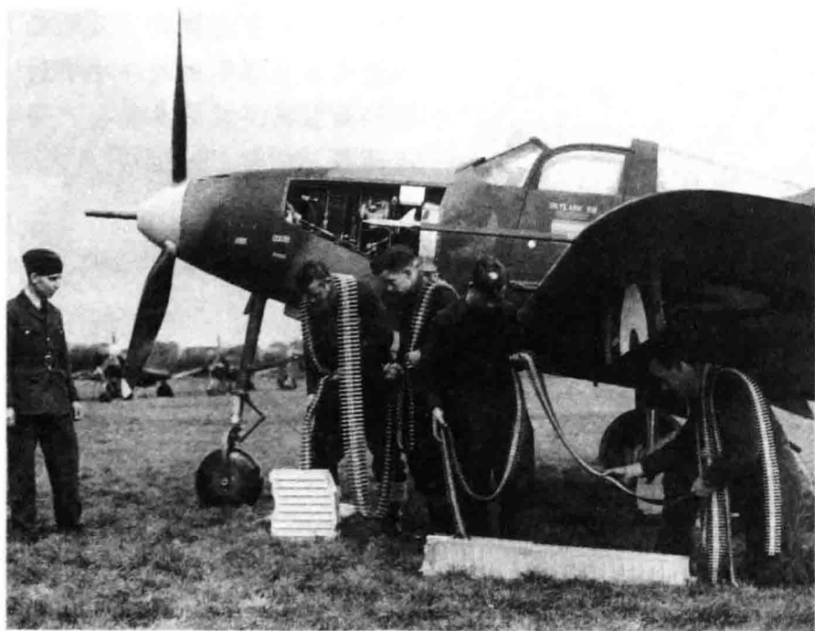
↑1941年，架设在机身前端的20毫米口径加农炮正被安装到英国皇家空军的贝尔P-39“空中飞蛇”战斗机上面。
