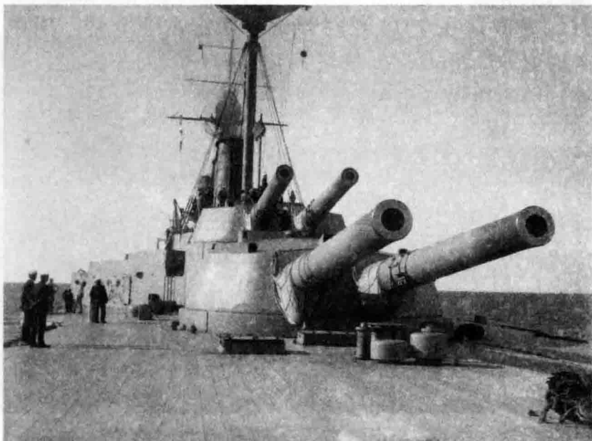
↑图为皇帝陛下舰船之“伊丽莎白女王”号上380毫米口径的舰炮。“伊丽莎白女王”级“无畏”舰是英国海军在第一次世界大战中所用杀伤力最大的一类“无畏”舰。
