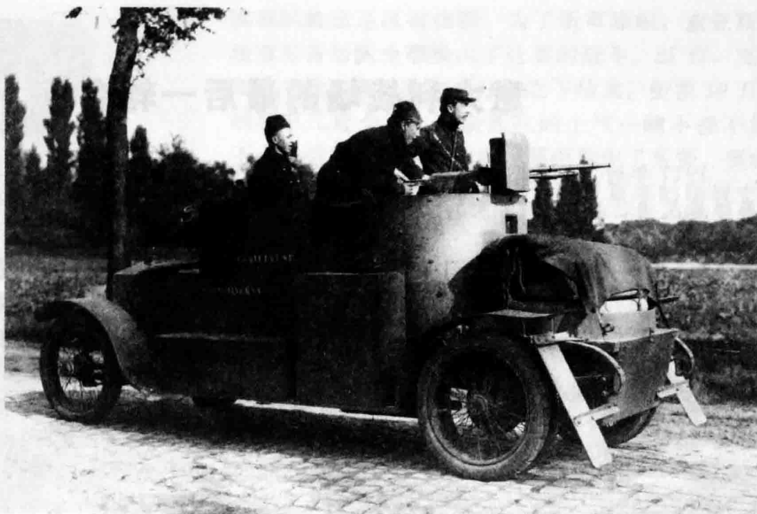
↑1914年参战的比利时密涅瓦装甲车只配备了一门霍奇基斯机关炮。
