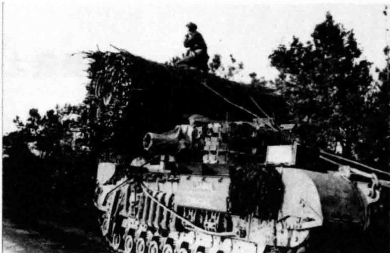
↑这是一辆在1944年晚期出现的英国皇家装甲工程车，图中还展示出其超大口径迫击炮和清除障碍的柴捆。
