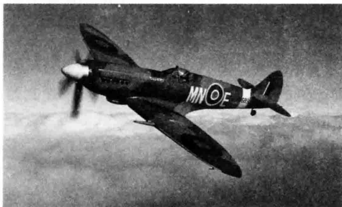
↑一架配有“狮鹫兽”引擎的喷火式马克14型战斗机在飞行之中。马克14型的最高飞行时速是721千米每小时。
