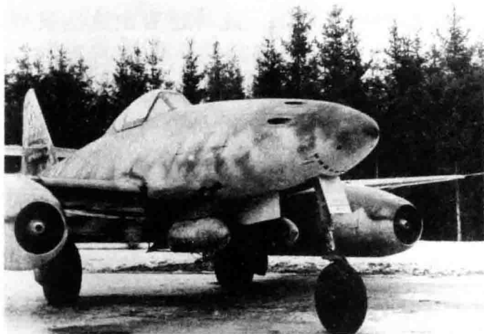
↑这是一架具有炸弹装备的 Me 262 式战机。希特勒曾坚持认为，这种机型应该被打造成快速飞行的轰炸机。
