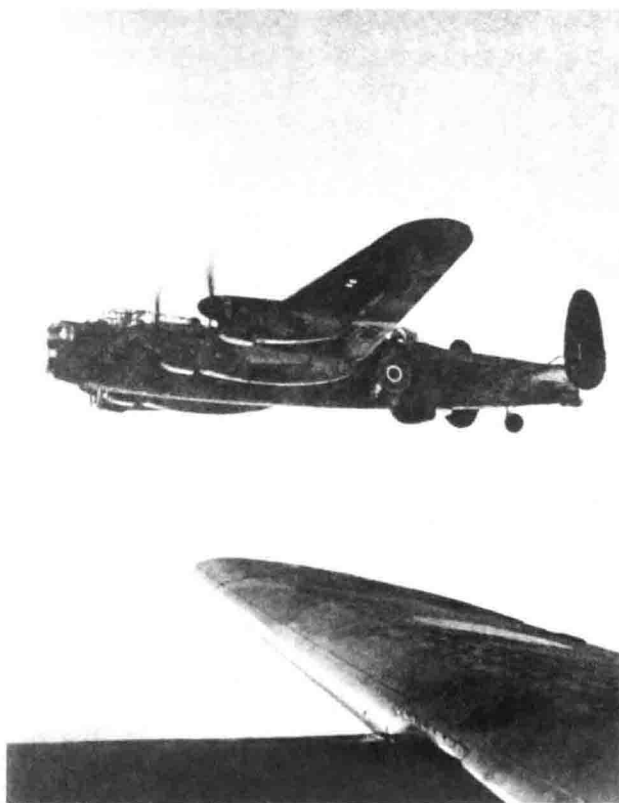
↑一架阿弗罗兰卡特战机在飞行中，其在机舱后面部分可以清楚看到其H2S的地面绘图泪滴设备，因为其具有抢眼的突出部分。
