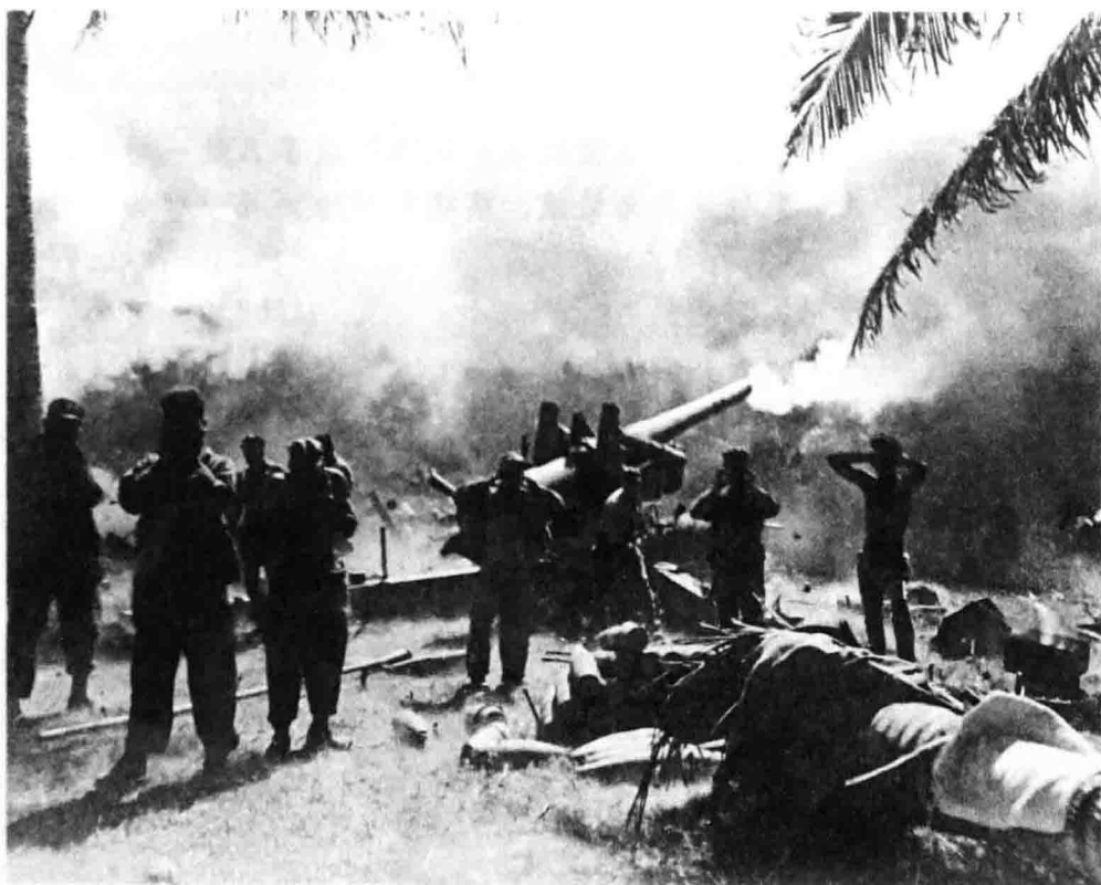
↑这是一架美国155毫米M1型“长汤姆”大炮，其在1944年11月于莱特岛战役中参加战斗。其分离双炮尾拖架结构的设计，使其具有一个非常稳定的发射平台。
