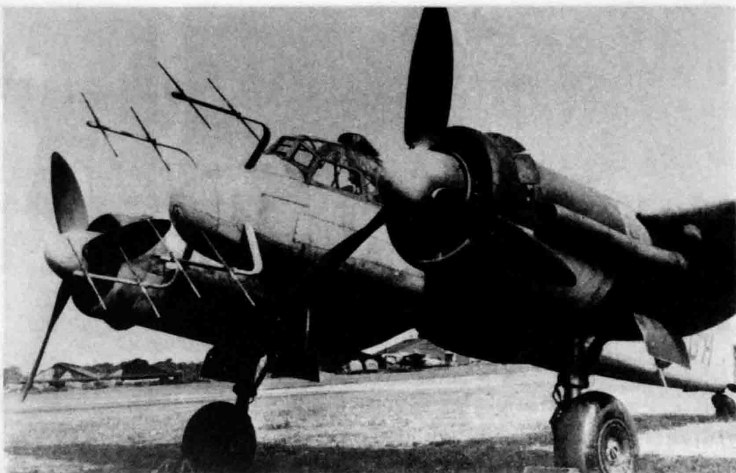
↑一架德国容克 88 式的夜间战斗机，配备了笨重的“明钻”SN-2 雷达设备的多振子天线。
