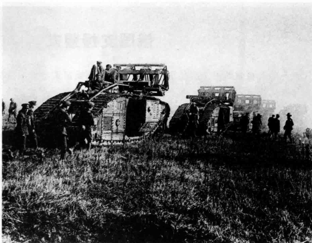
↑配置了越壕基架的马克V型坦克最早于1918年7月投入战斗。和之前的各款同类产品相比，这种坦克有更密集的火力和更强大的引擎。
