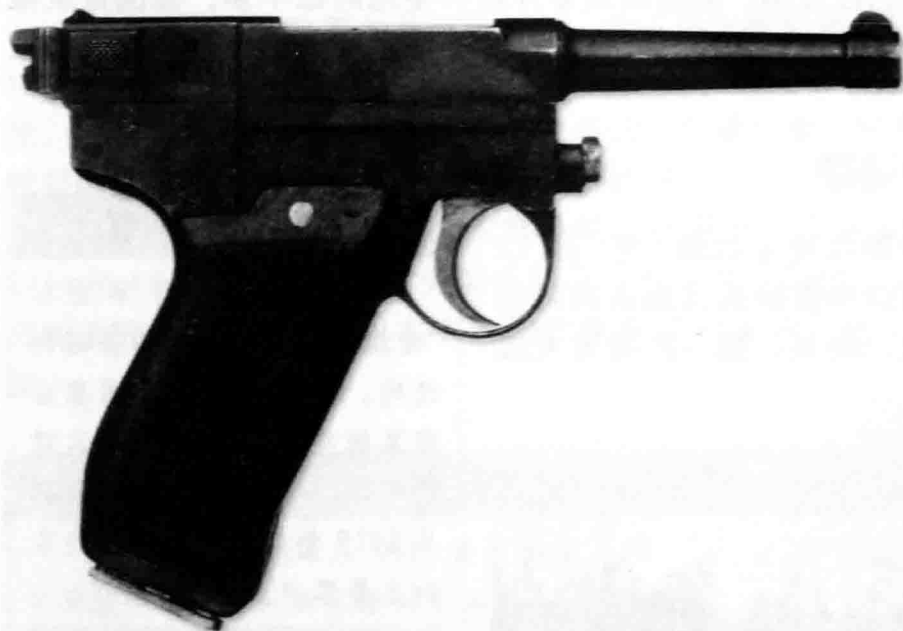
↑格里森蒂是一种可填入7发子弹、口径为9毫米的意大利手枪，枪体总长为216毫米，子弹出膛速度为275米/秒。
