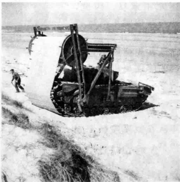
↑这是诺曼底登陆演习期间的一辆“丘吉尔地毯”号坦克。这种“地毯”坦克的席子，可以帮助有轮的战车顺利越过布满倒钩的障碍物。
