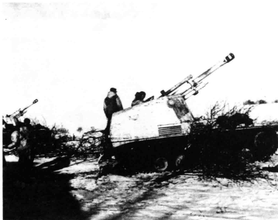
↑这是一架德国的“黄蜂”式 105 毫米火炮，其车身部分被刷白了，这是为了制造一种冬季的保护色。
