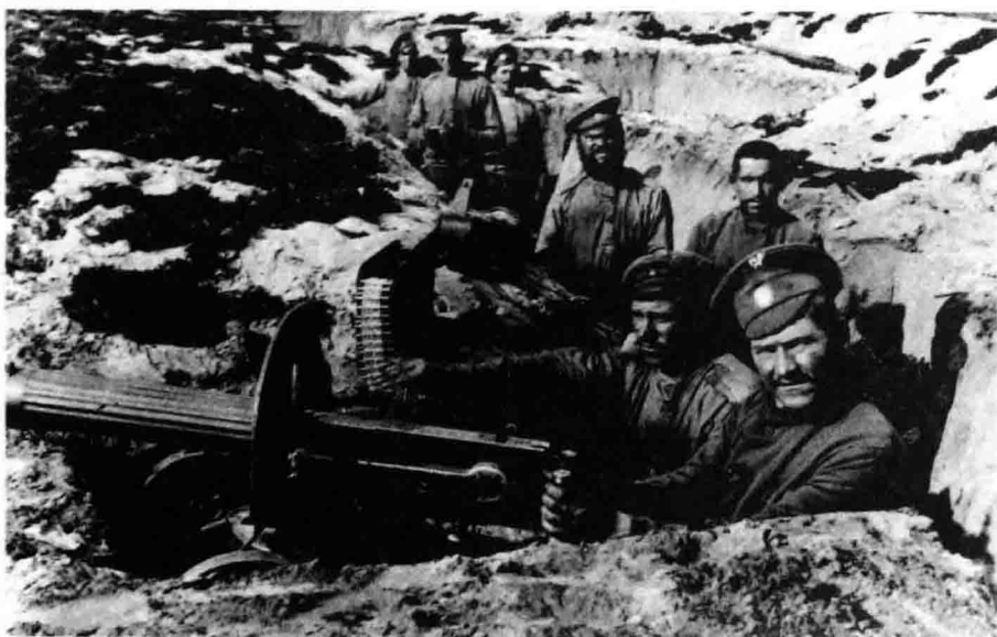
↑ 图为俄军的一挺M1910“索科洛夫”马克沁机关枪及其操作人员。这挺机枪上用来保护机枪手的防护装置是它的一大特色。
