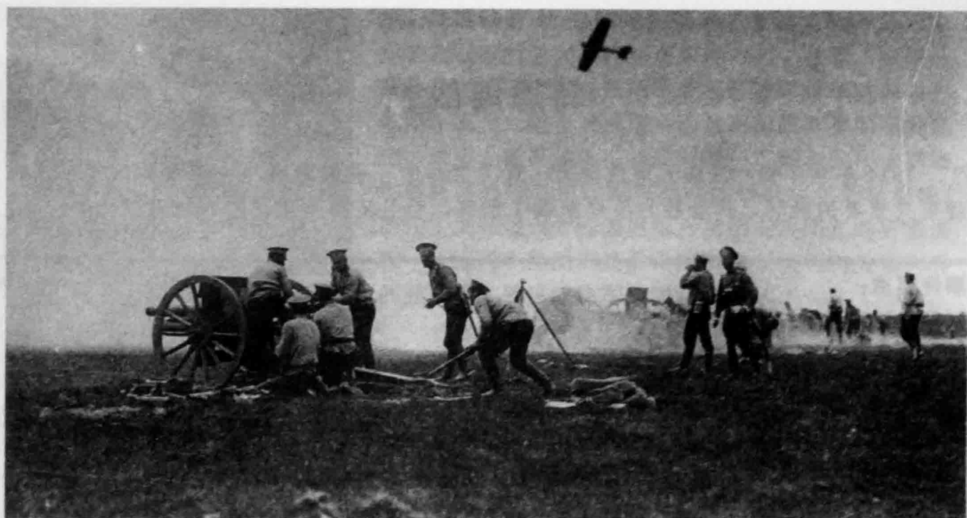
↑战争伊始，东线战场上的一台作战中的俄国 M1902 型 76.2 毫米口径野战炮。
