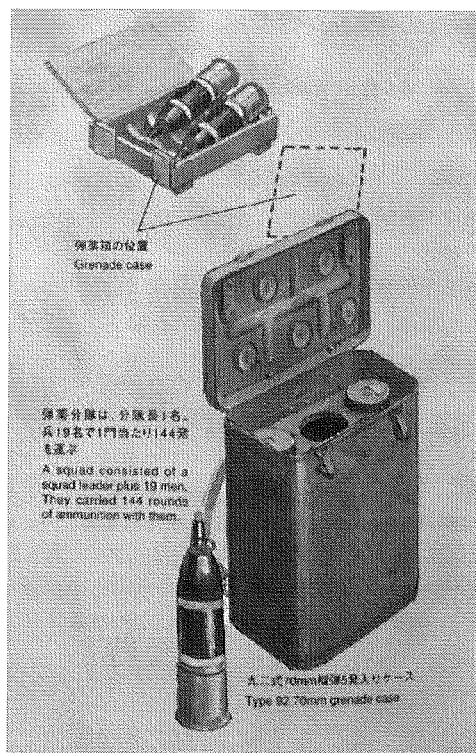
圖 1-4-3 92 式步兵炮彈藥箱，約 30 公斤，5 發，也有木箱式
