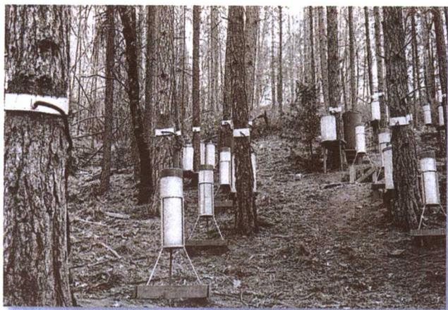
图 8.2 雨量计用来测定养分的输入。雨量计置于加利福尼亚的美国黄松林地上,截获森林树冠层落下和沿树干流下的降水量。分析雨量计中收集雨水的养分含量,有助于确定森林总养分的收支和矿物质循环的具体路径(感谢 The U. S. Forest Service)
