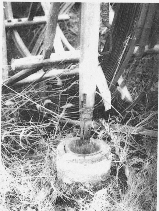
15 川北蓬溪县大英乡保留之卓筒井口与采卤风貌 (缪自平摄影)
