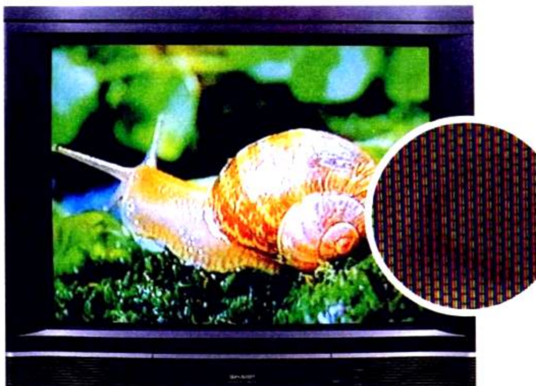
图4-18 原色光是红、绿、蓝。当原色光等量混合时，可形成白色光。彩色电视机的彩色图像是由红、绿、蓝按不同比例组合的结果。
