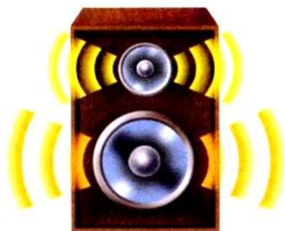
图2-7 扩音器通过锥形体的振动发出声音。锥形体振动的振幅越大，声音的音量或者说响度也越大。
