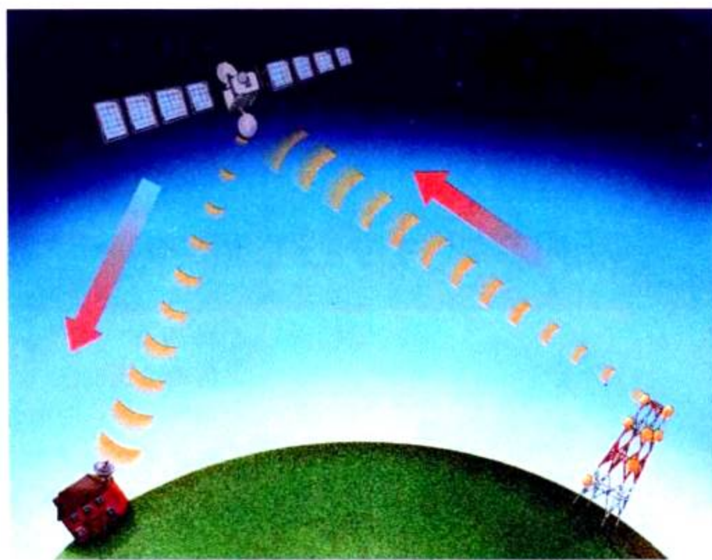
图 3-25 通信卫星是沿地球轨道飞行的遥控飞船。由于电磁波是直线传播的,电波不能沿着地球弯曲的表面直接到达另一地点。卫星接收来自地球的信号,然后把这些信号传送到电磁波无法直接到达的地球上的其他地点。
