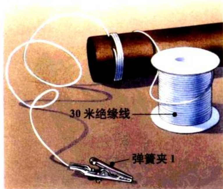
图1 绕制收音机芯
