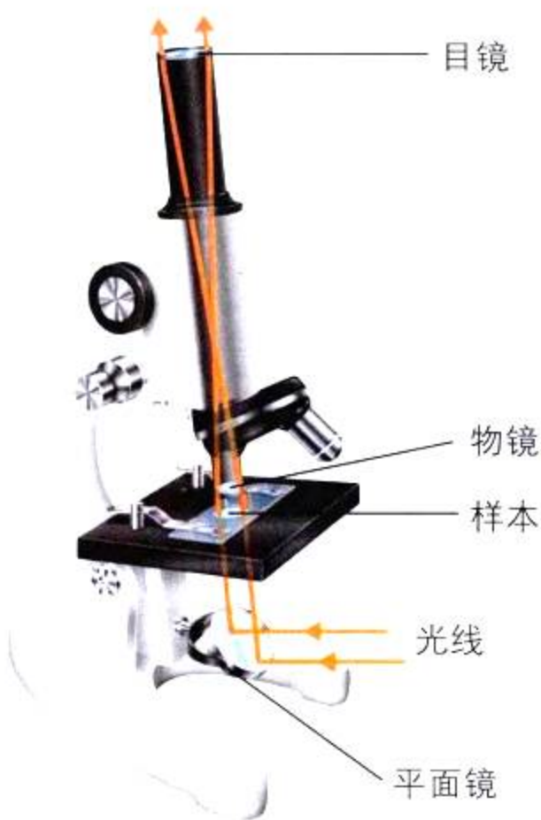
图 4-26 显微镜用透镜的组合形成小物体的放大的像。用显微镜能观察微生物(例如单细胞的海藻)。
