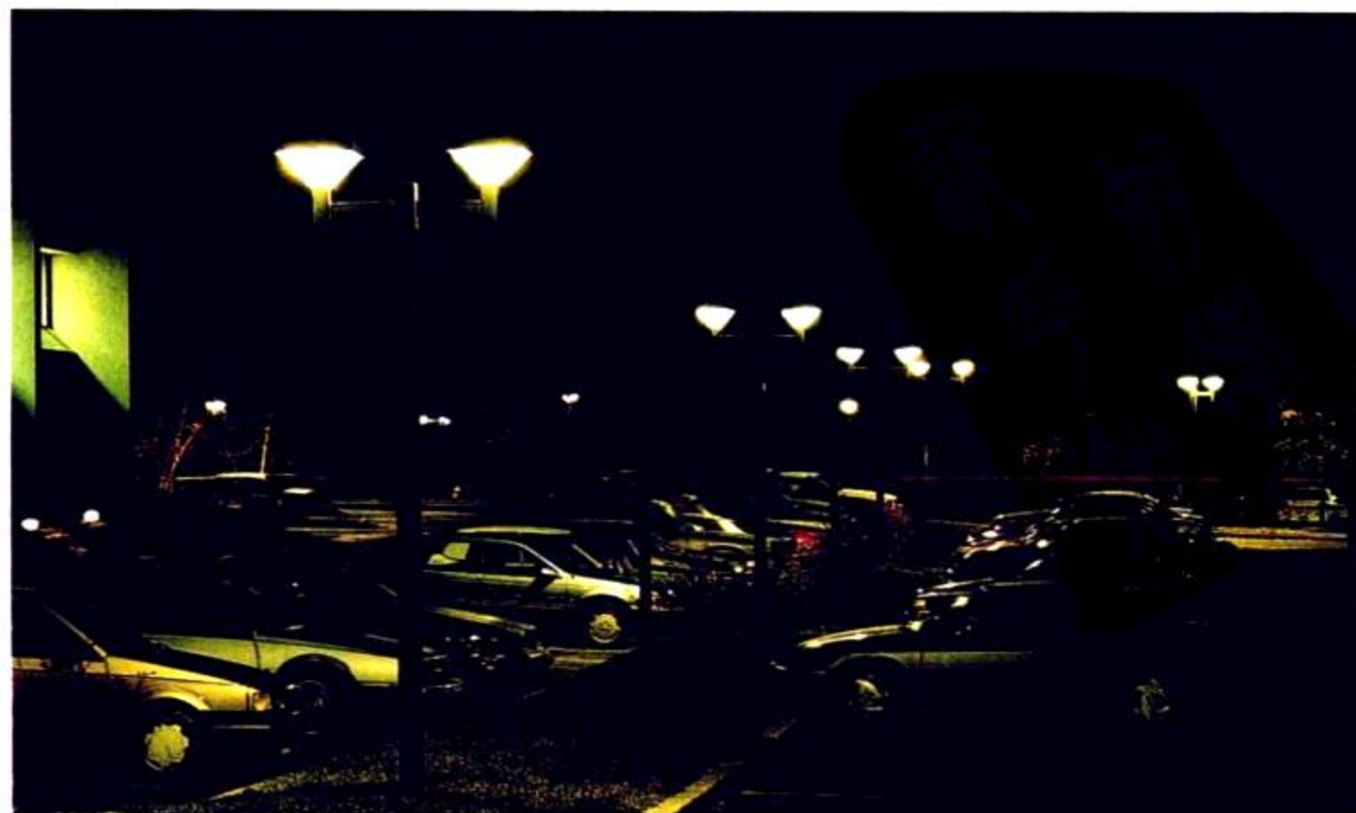
图 3-18 钠蒸气灯发出黄色光。钠蒸气灯常用于街道和停车场照明。
