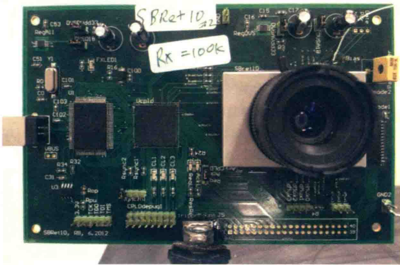
图 14-4 动态视觉传感器 (DVS)。(上图) 托拜厄斯·德尔布吕克拿着他在苏黎世大学神经信息学研究所发明的 DVS 相机。这种相机采用了专用芯片, 可以异步发射脉冲, 而不是像数码相机那样按帧采集图像。(下图) 相机的镜头将图像聚焦在模拟超大规模集成电路芯片上, 芯片会对每个像素上光强度的增加或减少进行检测。脉冲沿着“开启”(on) 导线发出正增量, 并沿着“关闭”(off) 导线发出负增量。输出脉冲由电路板处理, 电路板会显示出例如方框 14.1 中的脉冲图案。你的视网膜是一台非常先进的 DVS 相机。来自视网膜的脉冲图案在大脑中发生了转换, 但该模式仍然保留了脉冲——你的大脑中并不存在任何完整的图像, 即使你是以这种方式感知世界的。上图来源: 托拜厄斯·德尔布吕克。下图来源: 三星。
