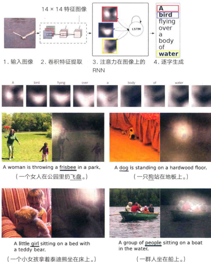
图 9-4 深度学习为图片做标注。顶部的一组图片说明了分析照片的步骤。ConvNet (CNN) 在第一步中标记了照片中的对象, 并将其传递给循环神经网络 (RNN)。RNN 被训练输出适当的英文单词串。底部的四组图片则阐明了进一步细化的过程, 即使用注意力 (白色云) 来表示照片中单词的指示对象。顶部来源: M. I. Jordan and T. M. Mitchell, "Machine learning: Trends, Perspectives, and Prospects," Science 349, no. 6245 (2015): 255–260, 图 2。底图来源: Xu et al., "Show, Attend and Tell," 2015, rev. 2016, figure 1 and 3, https://arxiv.org/pdf/1502.03044.pdf , Courtesy of Kelvin Xu。
