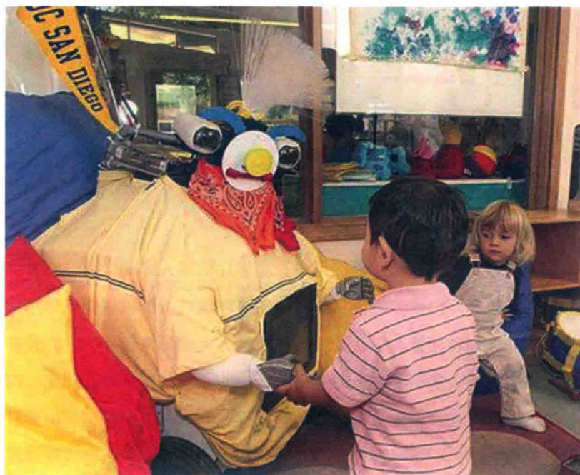
图 12-2 Rubi 在教室里与幼儿们进行互动。Rubi 的头可以旋转，眼睛是相机，嘴和眉毛都十分富有表现力。Rubi 头顶上浓密的光纤会随着它的心情而改变颜色。图片来源：哈维尔·莫维兰。
