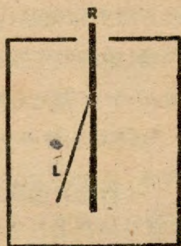
圖二十——一個簡單的驗電器。R爲一絕緣了的金屬棒，其上附有一片輕的金屬葉L。棒帶電時，葉被推開。如棒的附近有離子（不論正負）存在，它將符號相反的離子吸引到自己上面，故而失去電荷。葉的逐漸落下即證明電荷的損失與離子的存在。
