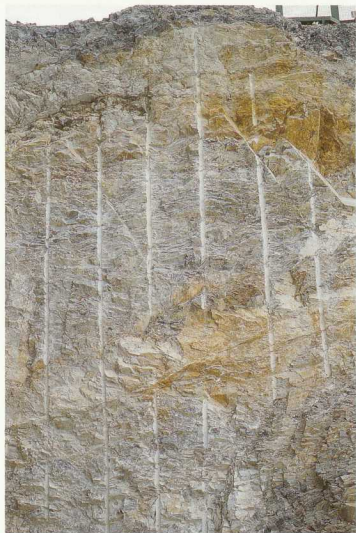
左上圖：開鑽細管後，埋入雷管、炸藥。 左下圖：開炸後，塊狀掉落的岩塊，露出鑽孔痕跡。 右上圖：此等礫山逐片炸落。 右下圖：眼前所見石灰岩山將全面炸空。
