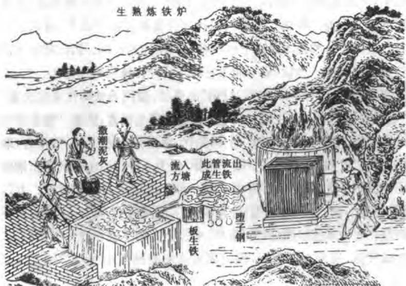
图 7-6 明代炼铁炉和炒铁炉串联的操作方法
