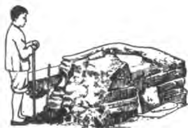
图 9-5 云南的毛铁炉以及毛铁炉鼓风情况
