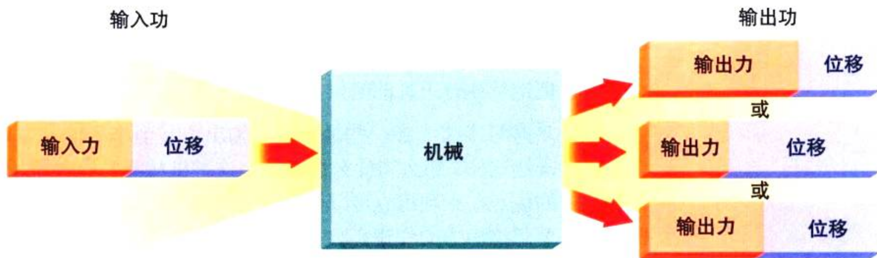
图 4-5 机械可以通过上述三种途径中的一种，使工作更轻松。
