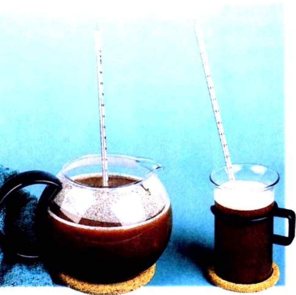
图6-3 大罐子里装的热可可温度与小杯中的可可温度相同。
