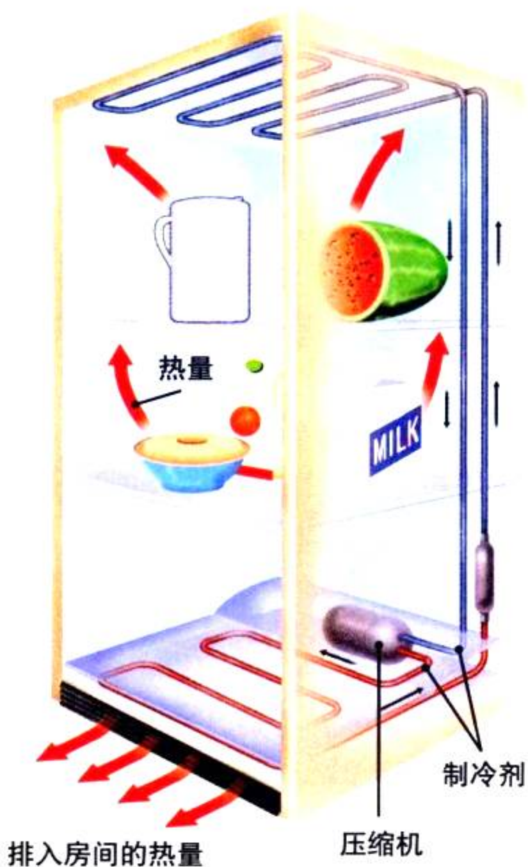
图6-19 这幅图显示了电冰箱的基本构造。
