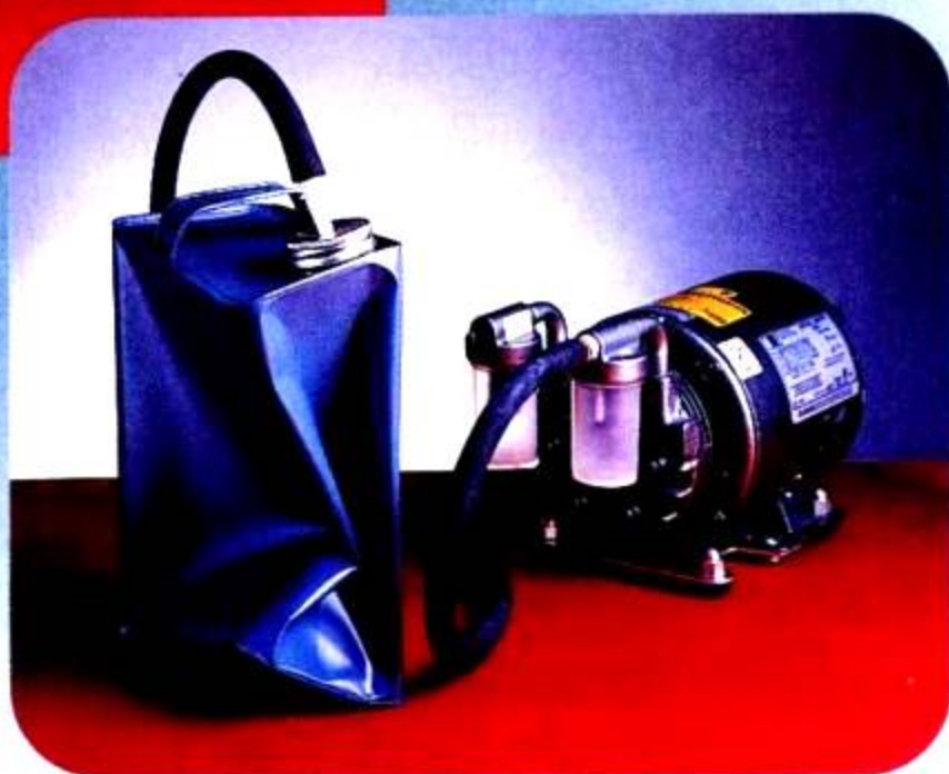
图3-5 真空泵正从一金属罐中抽去空气。一会儿工夫，金属罐就大变样了。
