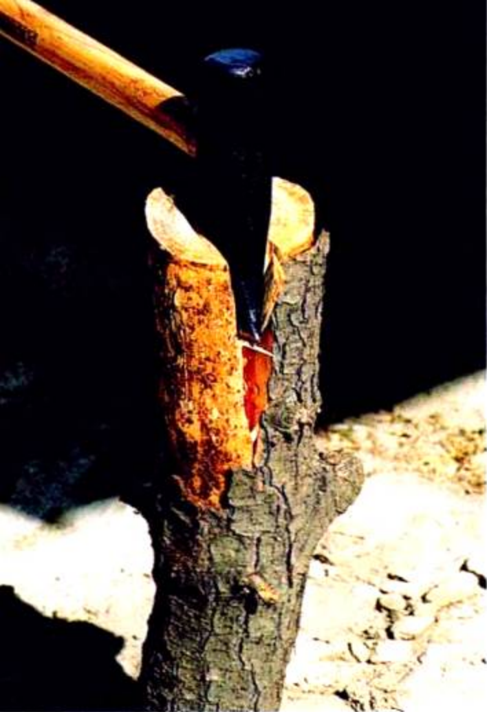
图 4-12 用手掰开一块圆木是不可能的，但楔能将一个力放大许多倍。利用楔，只需要一个很小的力就能将木头劈开。
