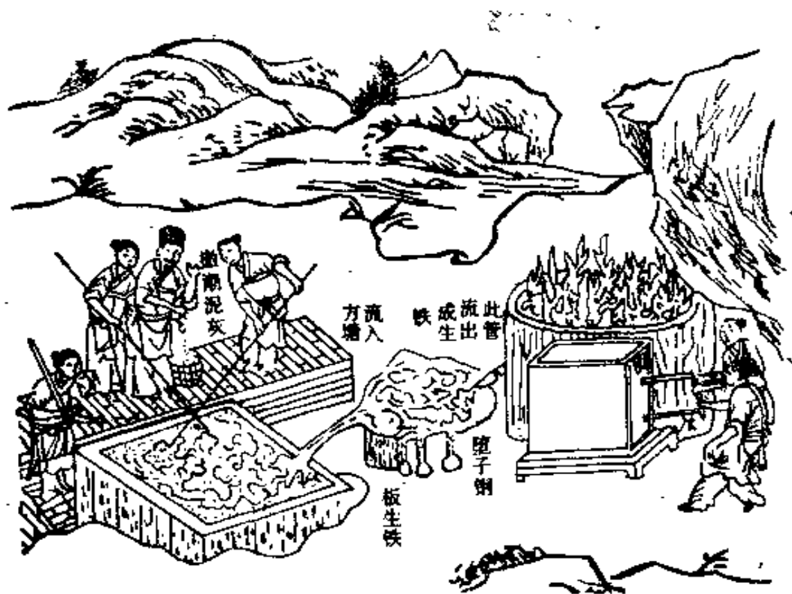
图8 生熟炼铁炉（采自《天工开物》）
