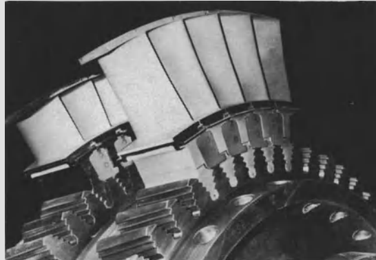
Abb. 19.7.6. Gasturbinenläufer von Sulzer. Schaufelfüße besitzen verlängerte Halsstücke zur Verminderung der Wärmeübertragung
