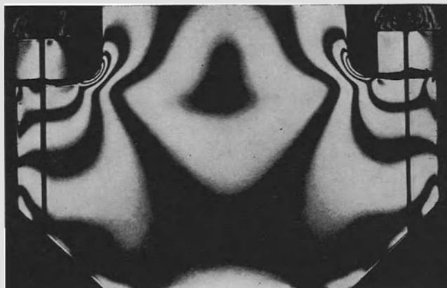
Abb. 16.9.1. Spannungsoptisches Bild der Spannungsverteilung in einem Hammerkopffuß
