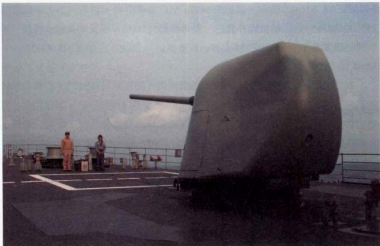
Mk.45 Mod.0進入美國海軍服役，除使用機械式信管設定裝置的Mod.0外，迄今Mk.45系列已推出使用電子式信管設定裝置的Mod.1、外銷型的Mod.2，以及換裝62倍徑砲管、提升膛壓使其發射傳統增程彈時最大射程可超過36km(使用更先進的增程彈射程更可高達92km以上)的Mk.45 Mod.4。
