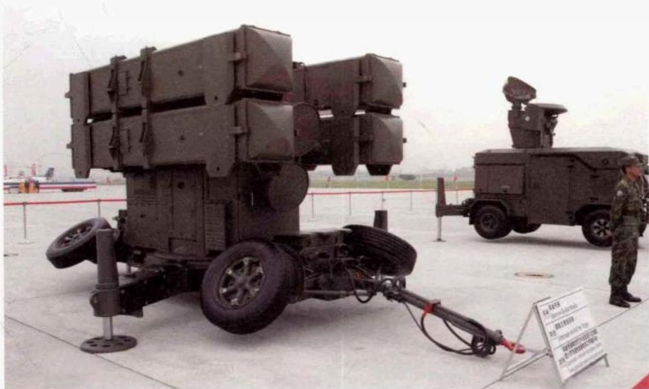
麻雀飛彈：國軍天兵系統使用的陸射型麻雀飛彈為RIM-7F，容納於一部擁有四聯裝發射箱的機動發射架內，其最大射程為20km、射高5,000m、接戰反應時間為8秒。發射前麻雀飛彈的彈翼處於折疊狀態，發射後彈翼張開並藉由安裝於發射架上的連續波照明雷達導引攔截目標。藉由天兵系統與麻雀飛彈的組合，形成以該系統為中心、半徑12km及高度5,000m的半球型防空網，有效防衛我軍機場的低空安全。
