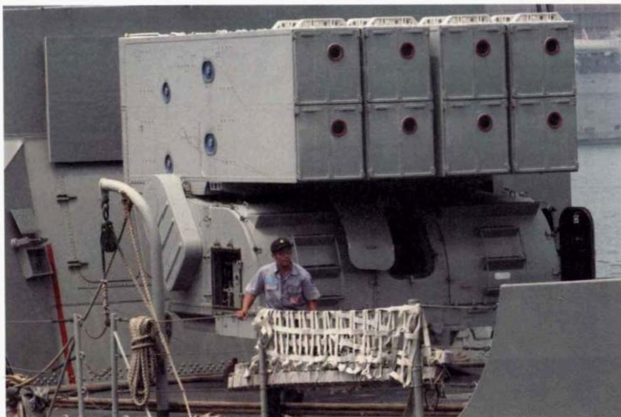
RUR-5型ASROC為「反潛火箭」(Anti-Submarine ROCKET)的英文縮寫，是美國漢威(Honeywell)公司在1950年代早期研發、1961年起大量服役的反潛武器系統，專供水面艦在敵方潛艦武器的最大射程之外進行反潛獵殺。雖然目前美國海軍的RUR-5 ASROC已被更先進的RUM-139垂直發射型ASROC(VLA)取代，但傳統的ASROC仍持續服役於我國海軍、日本海上自衛隊、土耳其海軍等部隊中。
