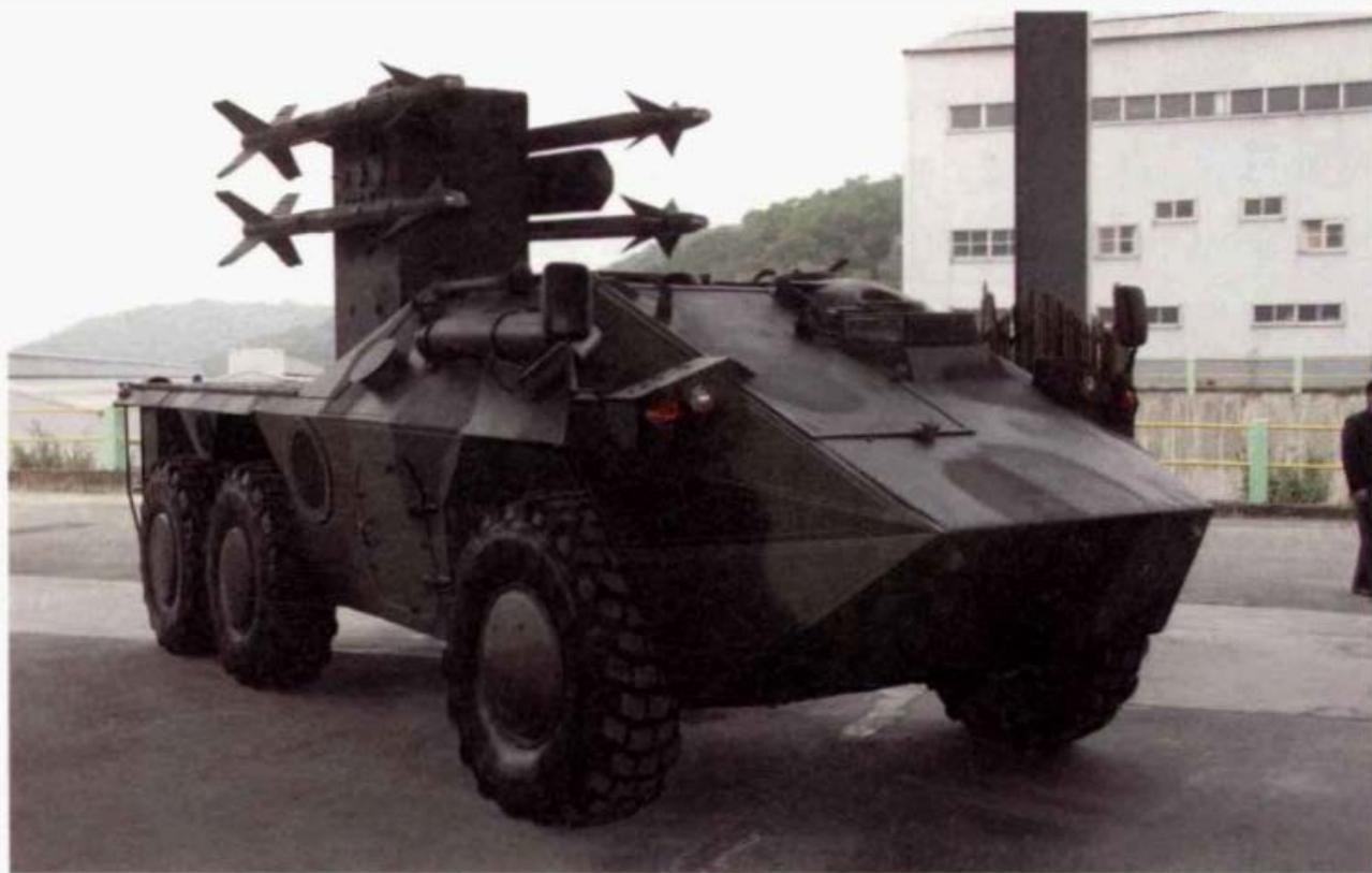
中科院捷羚系統曾安裝在兵整中心CM31輪型裝甲車的原型車上測試。
