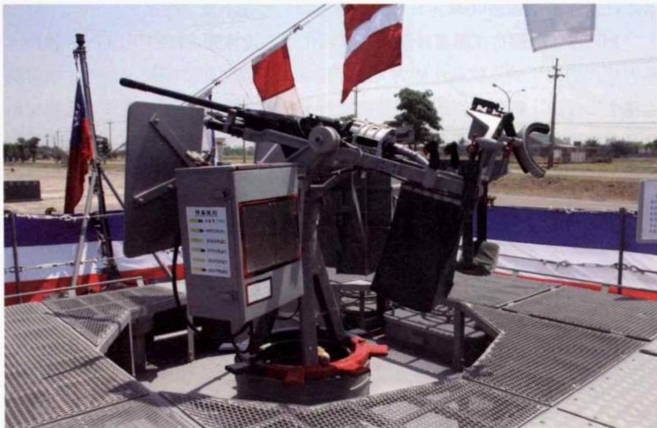
國造T-75S 20mm機砲是海軍在1980年代中為了取代老舊的美製奧立岡(Oerlikon)Mk.4 20mm機砲，以供一般運補艦及小型艦艇的近戰及防空武器需求，而將聯勤205兵工廠研製的T-75機砲改成的艦用版。
