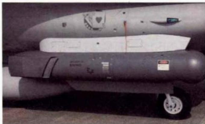
安裝於一具莢艙前方、可上下360度旋轉的圓球形轉塔，但AN/AAQ-14 (V) 1取消了原來AN/AAQ-14中的空對空模式以及飛彈瞄準裝置，使其不具備為紅外線導引型小牛飛彈(AGM-65D)提供自動鎖定的功能。因AN/AAQ-14 (V) 1與AN/AAQ-20莢艙為成對的系統，故國軍在1998年6月簽約採購「探路者」莢艙時，自然引進了相同數量的神射手莢艙掛載於F-16進氣道右下方的SR掛載點(探路者莢艙則掛載於F-16進氣道左下方的SL掛載點)。
