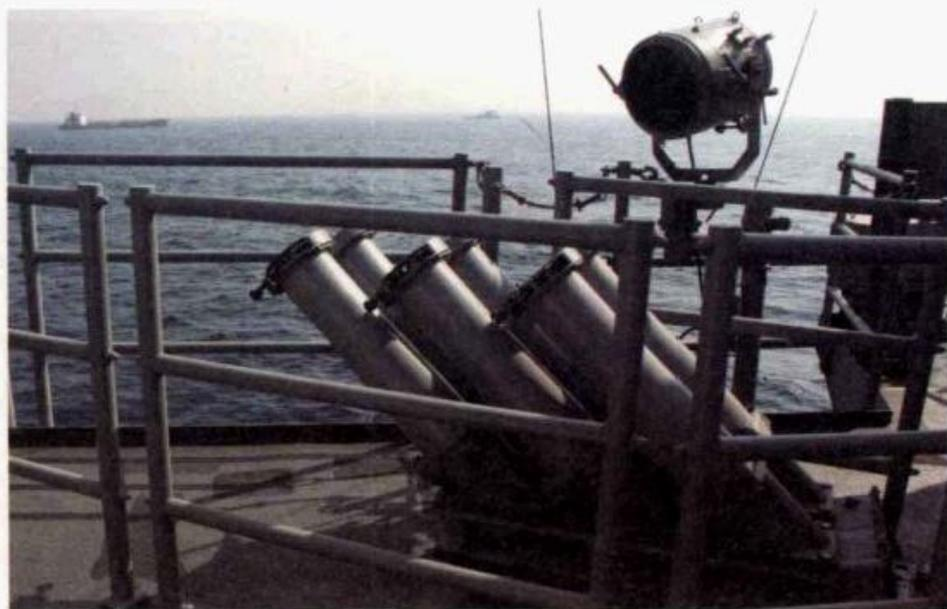
上的電戰系統、射控系統、紅外線警示器，及其它威脅警示器自動操作，干擾來襲的雷達及紅外線導引型反艦飛彈。
