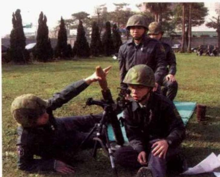
其砲身重4.7kg、高強度合金鋼材質的底板重3kg、鋁合金材質的砲架僅重4.6kg，再加上瞄準鏡的重量仍較前一代國造44式60公厘迫砲減少近7kg；所以一舉取代了國軍原先的31式及44式兩種同口徑迫砲，成為陸軍及海軍陸戰隊步兵連的主要支援火力。外觀上最大特徵除了底板從方形改為圓盤，可提供砲身360°迅速調整射向外，砲管上增設手提握把，使它不用上肩也能提著迅速運動。
