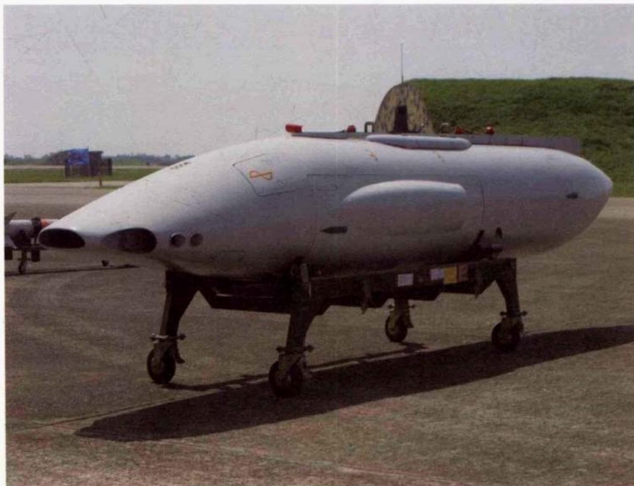
5Ei型單座戰機使用內置式的DEF A554作為固定武裝之外，我國也採購了使用DEF A554型機砲的雙聯裝莢艙以供幻象2000-5Di型雙座戰機掛載。
