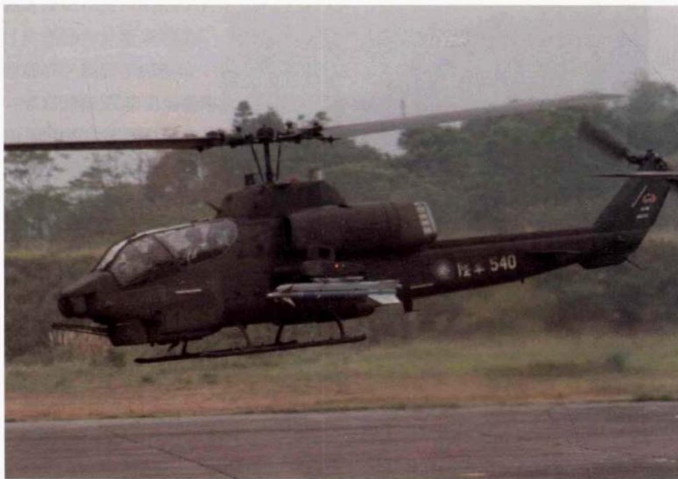
性需求，貝爾公司也生產了雙引擎版的AH-1J、AH-1T「海眼鏡蛇」（Sea Cobra）攻擊直升機。1981年，由於美國國會駁回陸戰隊的AH-64攻擊直升機採購案，陸戰隊只好尋求貝爾公司研發動力提升型的AH-1以應付1980年代的作戰需求。為此，貝爾公司將原本用於向伊朗巴勒維王朝推銷的AH-1T+性能展示機換裝通用動力公司（General Electric）的T700-GE-401渦輪軸引擎，並於1983年11月出廠試飛。由於陸戰隊對AH-1T+展示機的測試結果頗為滿意，乃於1985年下單訂購使用T700-GE-401引擎的眼鏡蛇直升機，並賦予AH-1W的編號。1986年3月，第一架AH-1W超級眼鏡蛇攻擊直升機出廠，成為1980年代之後美國海軍陸戰隊攻擊直升機的主力，並在波灣戰爭中大放異彩。
