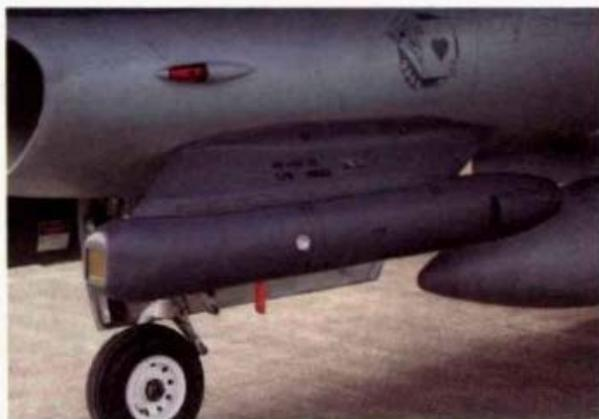
整套LANTIRN系統是由AN/AAQ-13導航莢艙及AN/AAQ-14標定莢艙所組成，其中前者因技術較為敏感，故洛馬公司後來又推出了取消地貌追蹤雷達而僅保留前視紅外線偵測器(FLIR)的AN/AAQ-20「探路者」(Pathfinder)莢艙以供海外客戶使用，由於其功能較少，因此飛行員雖然可以使用FLIR進行夜間及惡劣天候下的低空飛行，但因缺乏地貌追蹤雷達提供自動飛行的功能，飛行員的操作負荷就會比較沉重(註解)。
