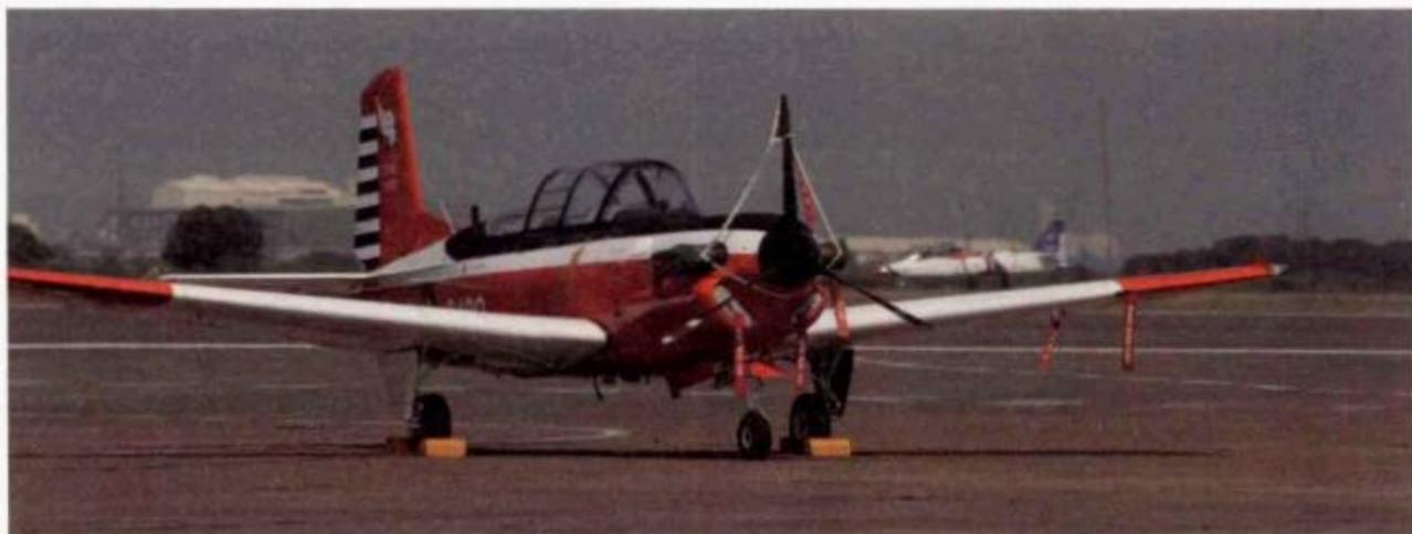
T-34良師（Mentor）教練機的研發可追溯至1940年代，當時美國畢琪飛機（Beechcraft）公司自行研發了一種由Model 35輕型飛機衍生而來的Model 45單活塞引擎教練機，並向美國軍方推銷以試圖取代廣泛使用的T-6「德州人」（Texan）式教練機。相較Model 35，Model 45擁有強化的機身結構，並以單片式垂直尾翼取代Model 35的V型雙垂直尾翼。至於引擎方面，前兩架Model 45T原型機使用一具185shp的大陸（Continental）E-185活塞引擎，第三架Model 45T原型機則使用出力225shp的大陸E-225引擎。1948年12月2日，第一架Model 45原型機首度試飛，但首架量產的T-34A直到1953年才移交美國空軍，隨後美國海軍也於1955年接收T-34B作為訓練海軍飛行員之用。
