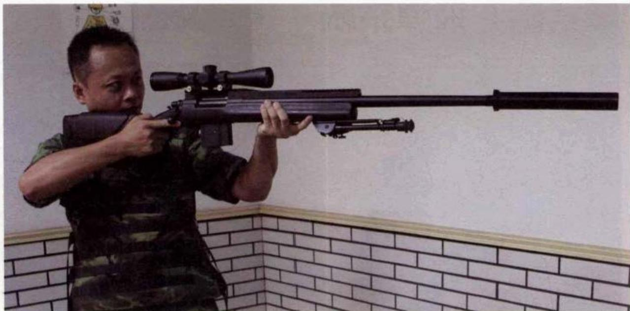
2012年205廠最新公開的T93K1狙擊槍，改採彈匣給彈、狙擊鏡及國造減音器。
