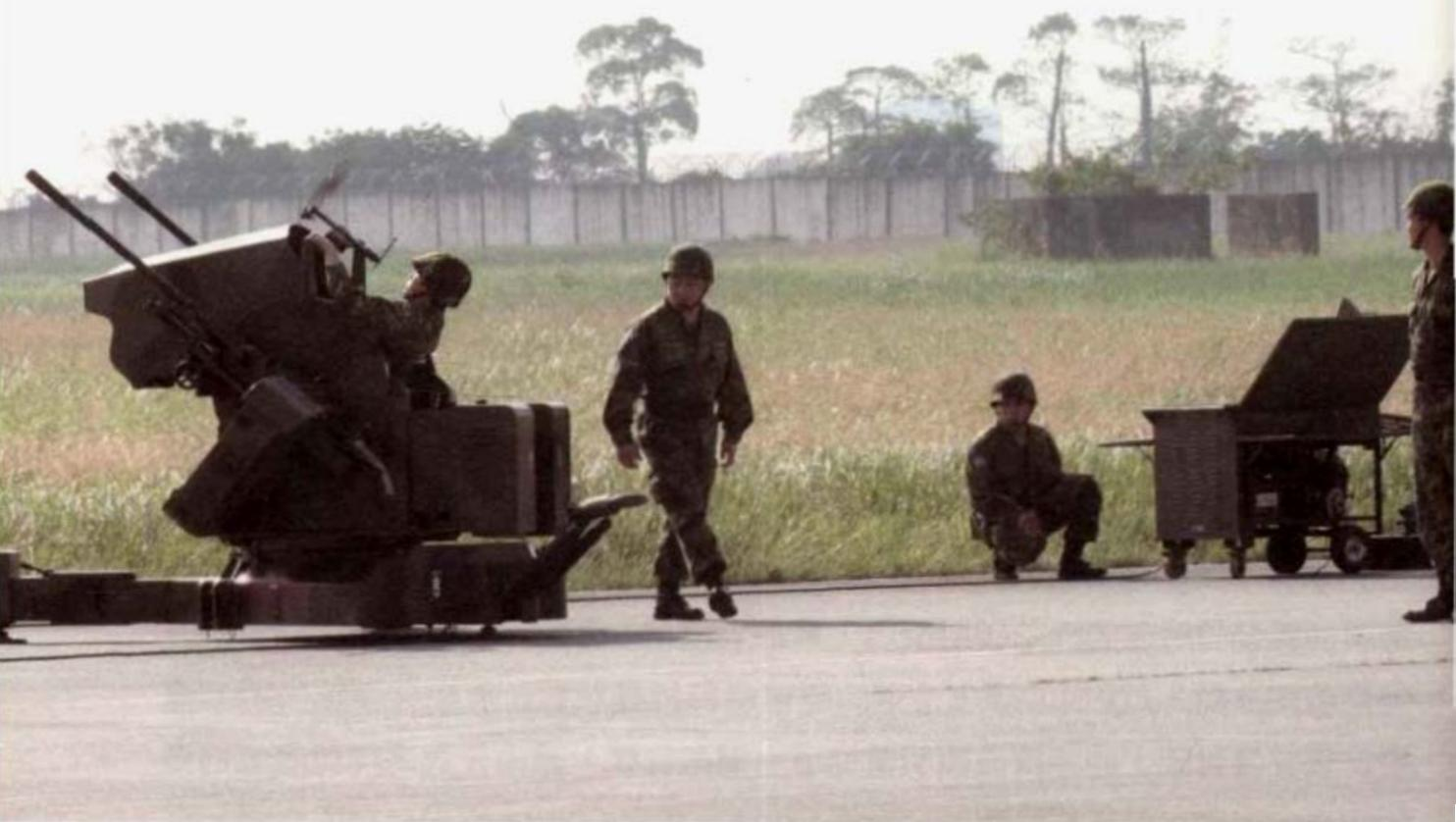
聯勤第205廠推出T75機砲後，最初只獲得海軍及陸戰隊的採購。因此該廠又以2門T75機砲併列而設計出T82型雙聯裝機砲，其中T82T型配備有路輪，可用機動車輛拖曳快速放列至任何需要位置，如其伺服馬達故障，也可採用人工方式操作。一舉汰換了生產於二戰時期的M55型四管12.7公厘機槍座，贏得陸、空軍的青睞。
