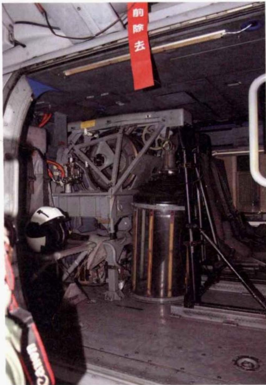
裝置於S-70C(M)反潛直升機後艙的AQS-18(V)3型吊放式聲納與AN/ARR-84被動式聲納浮標接收器。
