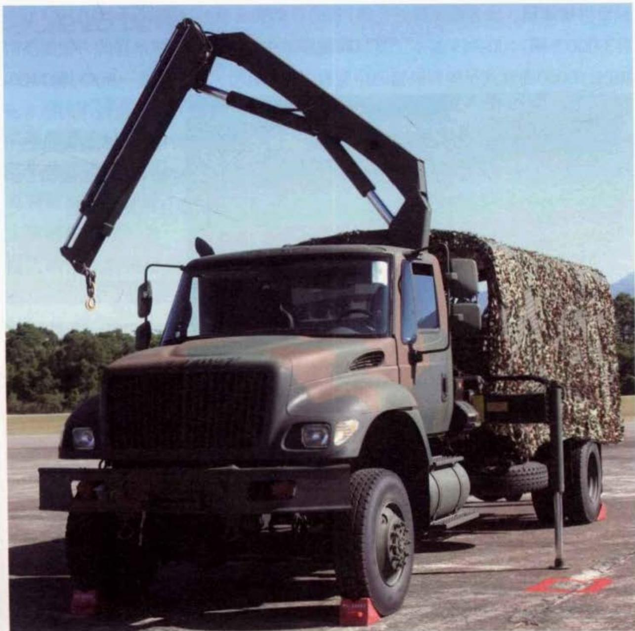
附加PK10000曲臂式吊桿與絞盤的中型戰術輪車H型。
