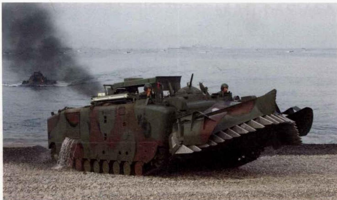
LVTP5-E1工兵車除了在車頭前方裝有大型除雷鏟外，其車頂還安裝有一組爆破索發射架。
