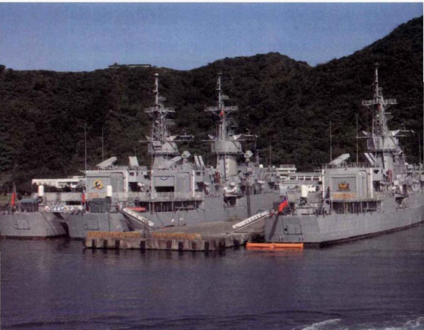
靠泊在宜蘭蘇澳軍港的濟陽級巡防艦，從直升機機庫上的SM-1防空飛彈發射箱，即可以辨識它們已改裝武進三型系統。
