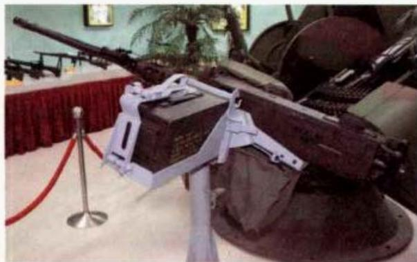
T90式重機槍雖然發展自M2 HB 205廠參考M2 HB所研發的T90式重機槍。重機槍，但205廠其實做了一些新的改變：最明顯的是T90式的槍管上有6道凹槽增加散熱面積，減少連續射擊時槍管過熱的現象；而槍管也和M2 HB QCB重機槍相同，能夠快速拆裝更換；槍管底部有螺紋接槽，直接插入機匣節套鎖上後即可射擊，無須調整。另外T90式重新參考國人體型，修改了握柄、提把及槍機拉柄的尺寸，在使用上更順暢省力。
