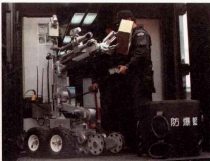
憲兵特勤隊防爆分隊配備的英國製防爆處理機器人，它可以配合上坡及下坡控制機器人重心移動，在斜坡移動、上下樓梯，以及拖拉重物。
