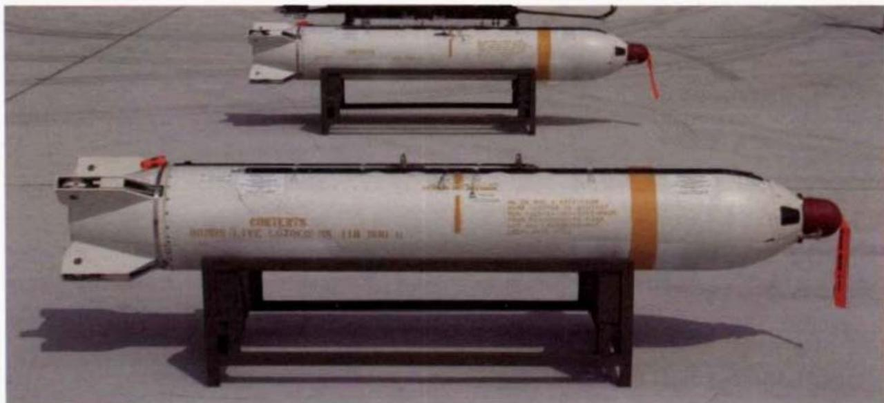
Mk.20「石眼二式」(Rockeye II, 空軍編號CBU-99及CBU-100)是美國在1960年代初期所研發,並在1960年代晚期使用於越南戰場的一種無導引、自由落體式集束炸彈,可用於攻擊戰車、裝甲車輛與其他軟性目標。每一組Mk.20包含了一具Mk.339引信、一套彈體可上下分離的Mk.7散佈器、247枚Mk.118反裝甲次彈械,當Mk.7散佈器的彈體外殼打開後,內含的次彈械就會隨之釋放散佈。每枚Mk.118總重1.32lb,內含0.4lb的高爆成形裝藥,當次彈械引爆時,可產生250,000psi的噴流以貫穿7.5in(190.5mm)厚的裝甲板。而Mk.20在152m(500ft)低空散佈Mk.118次彈械時的破壞面積為4,800m<sup>2</sup>,對敵軍裝甲部隊集結區或裝甲縱隊具有極大殺傷力。國軍獲得Mk.20的時間約在1980年代之後,可供F-5E/F、F-16A/B等機種掛載使用。
