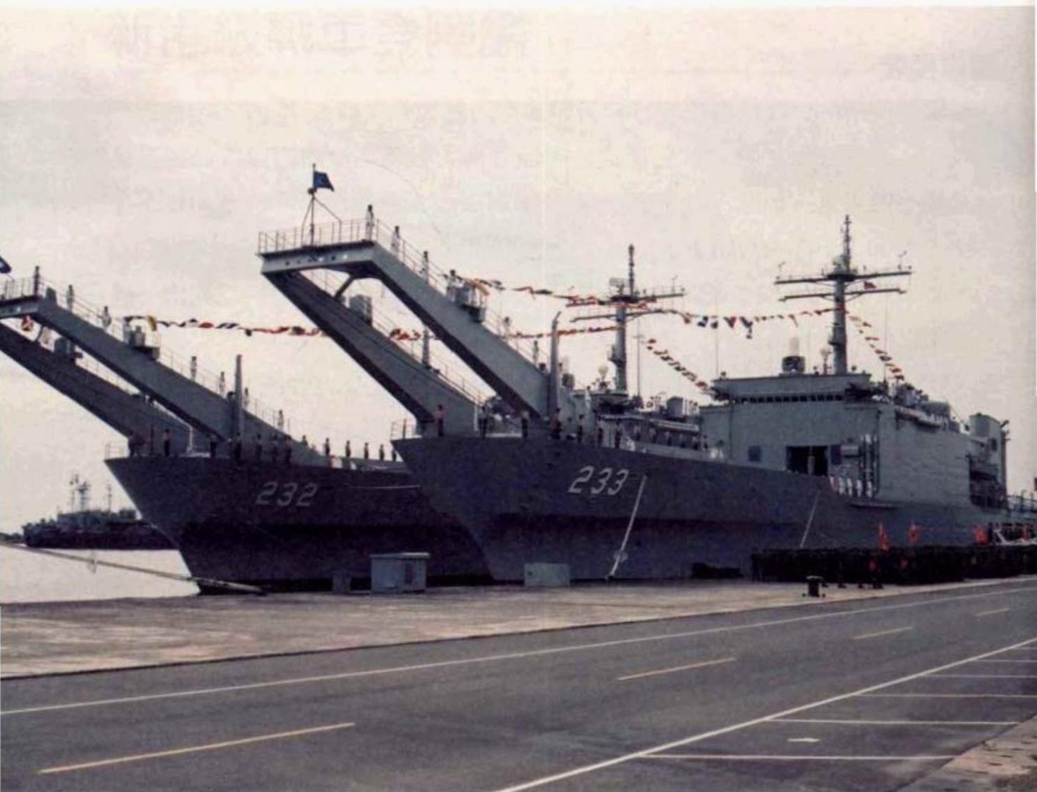
中和級戰車登陸艦巨型棧橋式登陸跳板及門形吊臂，用以取代傳統的「開口笑」式艦艏門，使艦體能擁有高速性能。
