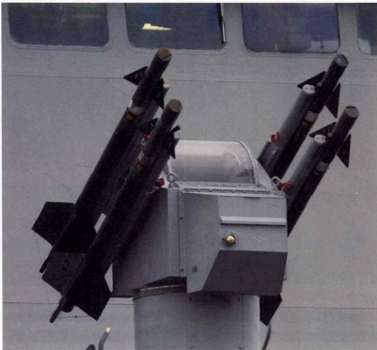
海欖(Sea Chapparal)紅外線導引防空飛彈為AIM-9響尾蛇空對空飛彈的艦載發射型，當陸射型的欖樹飛彈於1969年移交美國陸軍部隊之後，美國海軍因為亟需一種小型短程防空飛彈供在越南外海擔任雷達哨戒艦任務的基爾林級驅逐艦使用，故以欖樹飛彈為藍本推出海欖樹艦載防空飛彈。越戰末期的1972年，美軍曾在數艘基爾林級驅逐艦上裝設海欖飛彈作為短程防空武器，但並未正式納入制式裝備。我海軍於1975年首度引進海欖防空飛彈，安裝於佛萊契級
