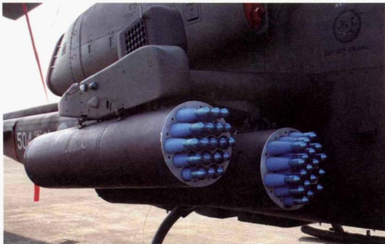
「海神」（Hydra）火箭是1970年代初期由Mk.4/40 2.75吋火箭發展而來的70mm無導引空射火箭彈，用以取代舊式的Mk.4/40等火箭作為美國陸軍、陸戰隊直升機，以及部分空軍、海軍航空隊定翼機的對地攻擊武裝。海神火箭使用一具Mk.66火箭發動機，因其改用燃燒時間較久的推進藥，故射程較早期Mk.4/40火箭更長。此外，海神火箭還可視任務需求換裝不同彈頭，包括了：人員殺傷用的M151（彈頭重10lb）與M229（彈頭重17lb）高爆彈（HE）、反裝甲的M247高爆彈（8.8lb成形裝藥彈頭）、M261高爆多重次彈械（MPSM）、M255A1/E1次彈械、M257照明彈、M156煙幕彈、M264煙幕彈、M267訓練彈、M274煙標訓練彈、M278紅外線信號彈等。
