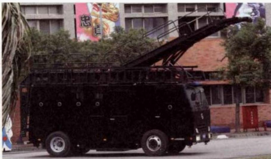
憲兵特勤隊配備的攻堅鋁梯車，其車頂攻堅梯可根據目標高度調整，讓突擊隊員直接衝入窗口。
