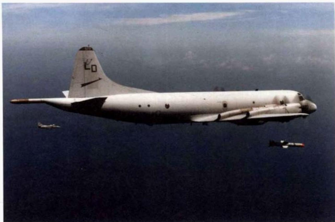
P-3作為反潛機而研製，其性能直到如今依然在所有定翼反潛機中首屈一指。首先是衡量反潛巡邏的最重要指標——航程，P-3達到了3.835公里（轉場航程8.945公里）。而且在實際反潛巡邏中，也不需要保持700公里時速。但也完全可以展現出P-3反潛機卓越的航程性能。另外，P-3的轉彎性能可以對海上目標進行半徑550m、角速度每秒9度的連續盤旋，在反潛作戰時，這樣的連續盤旋將極有利於確定目標和攻擊！
