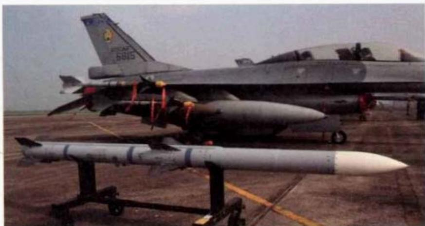
飛機公司於1970年代中期研發的主動雷達導引中程空對空飛彈。1982年AMRAAM進入全規模發展(FSD)階段，並於同年首次成功試射命中QF-102A靶機。1987年，AIM-120展開低率初期量產(LRIP)。1991年9月，AIM-120A獲得初始作戰能力(IOC)。1992年，AMRAAM進入全率量產階段。同年12月底，一架美國空軍的F-16D戰鬥機在執行伊拉克禁航區巡邏任務時，用一枚AIM-120A擊落一架伊軍MiG-25戰鬥機，創下AMRAAM首度擊落敵機的正式紀錄。此後AIM-120成為美國空軍、海軍、陸戰隊航空隊及世界30餘國廣為使用的主動雷達導引空對空飛彈，並曾於實戰擊落至少9架敵機。
