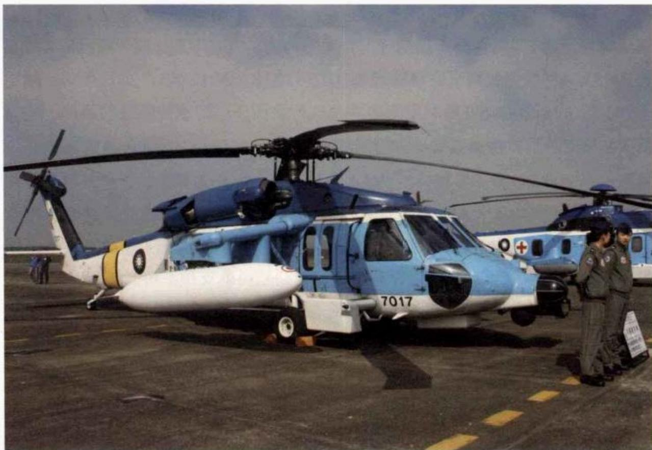
在外觀上與左圖S-70C-1最大不同之處，在於S-70C-6機首加裝的氣象雷達、前視紅外線偵測儀5萬瓦強力探照燈。
