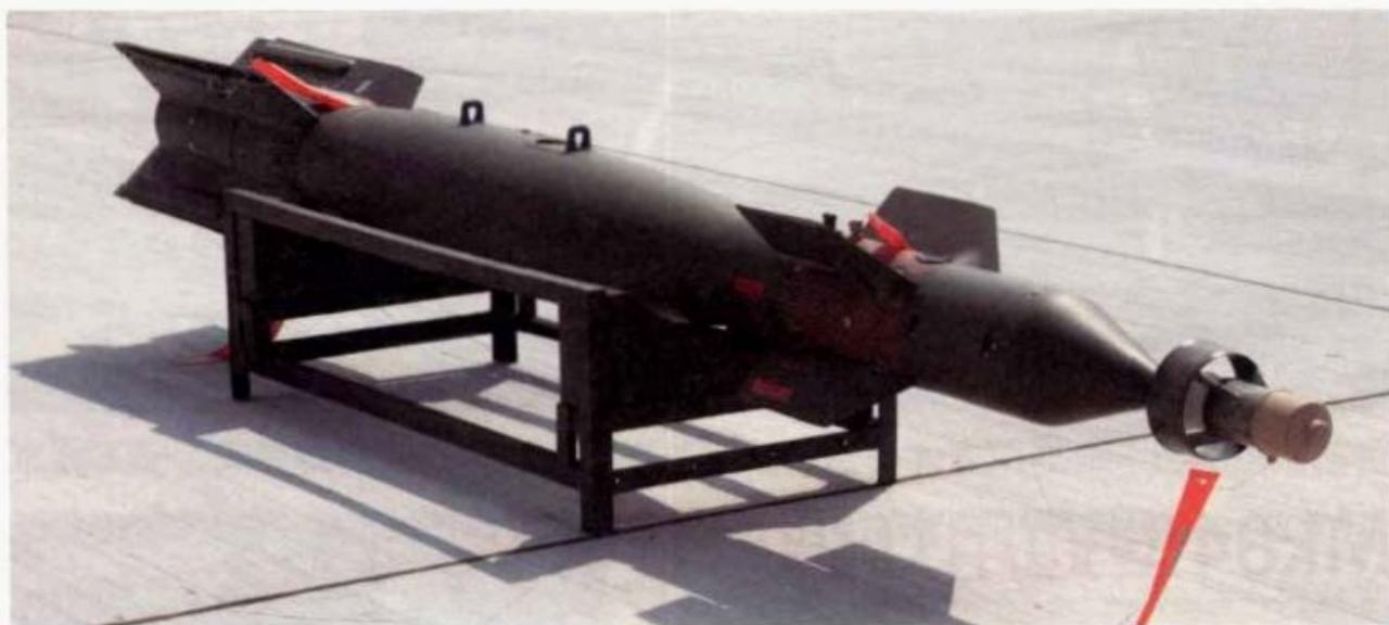
「鋪路」(Paveway)系列雷射導引炸彈(Laser Guided Bomb, LGB)是美國空軍在1964年委由德州儀器公司(Texas Instruments)所研發的精密導引武器，最初是將一組雷射導引套件加裝在傳統的M117自由落體炸彈上，藉由追蹤雷射標定器射出的雷射光束反射訊號以導引炸彈命中目標。1968年，第一批鋪路雷射導引炸彈投入越南戰場，用於攻擊北越橋梁等嚴密防守之目標。由於其高精確度(越戰期間創下86%命中率的佳績)以及比飛彈廉價的優點，使得雷射導引炸彈迅速成為美國空軍1970年代初期的主力精密導引武器。之後美方又改良其光電系統的偵測敏感度以強化其搜索與鎖定性能，成為所謂「鋪路二型」(Paveway II，因此早期的鋪路式改稱為鋪路一型)雷射導引炸彈。
