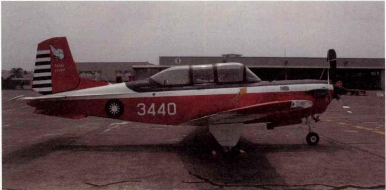
役，取代T-CH-1「中興」號教練機在空軍官校的初級與中級教練課程。這批T-34C-1因設計為具有攻擊能力，故加裝了光學瞄準儀，左右翼下方各有兩處掛載點，可掛載544kg的炸彈、火箭或機槍莢艙。我國空軍目前還有近40架的T-34C擔任空官的教練任務，學員需經過85個基礎飛行科目之後，方能進入高級教練階段繼續訓練。
