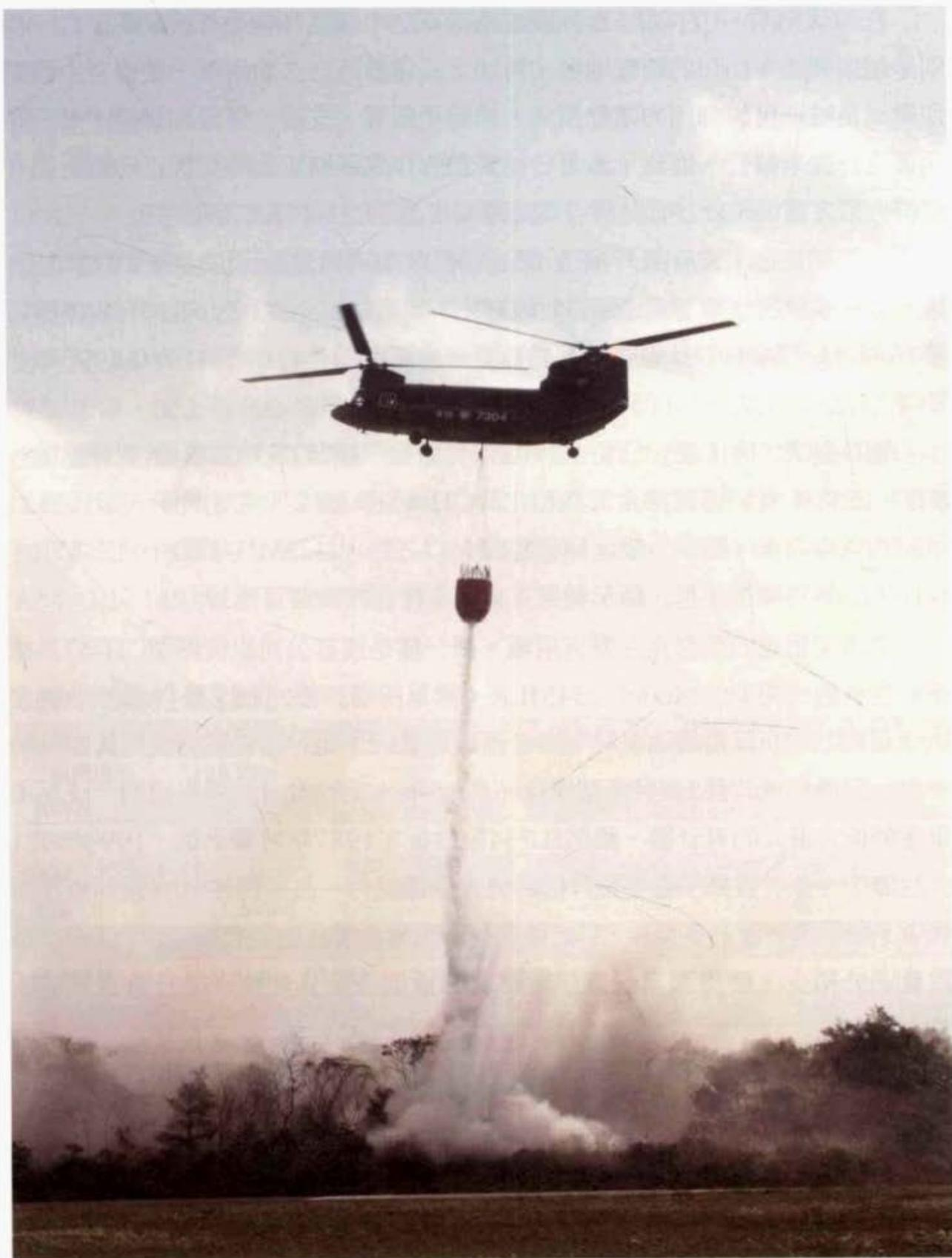
陸軍的CH-47SD仿效其移交給內政部消防署空中消防隊的B.234型機，從2008年開始也建置可供森林滅火的吊掛式水袋。
