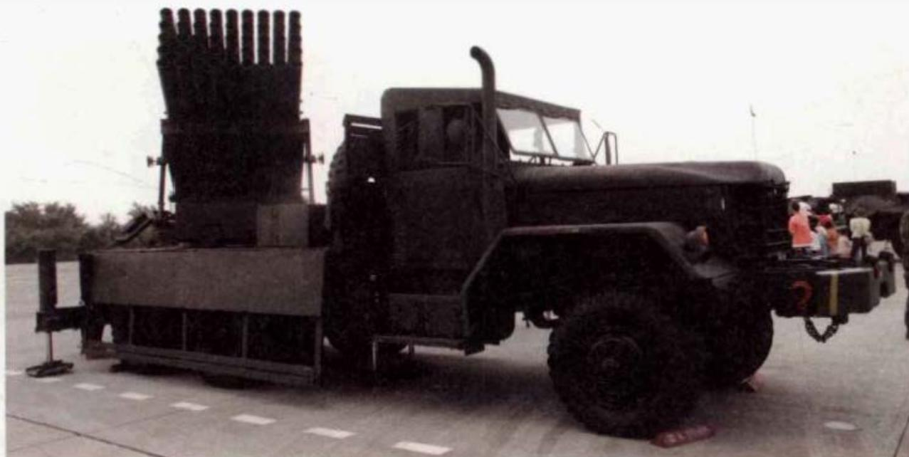
工蜂6型多管火箭系統以美造M809式5噸載重車為機動載具。
