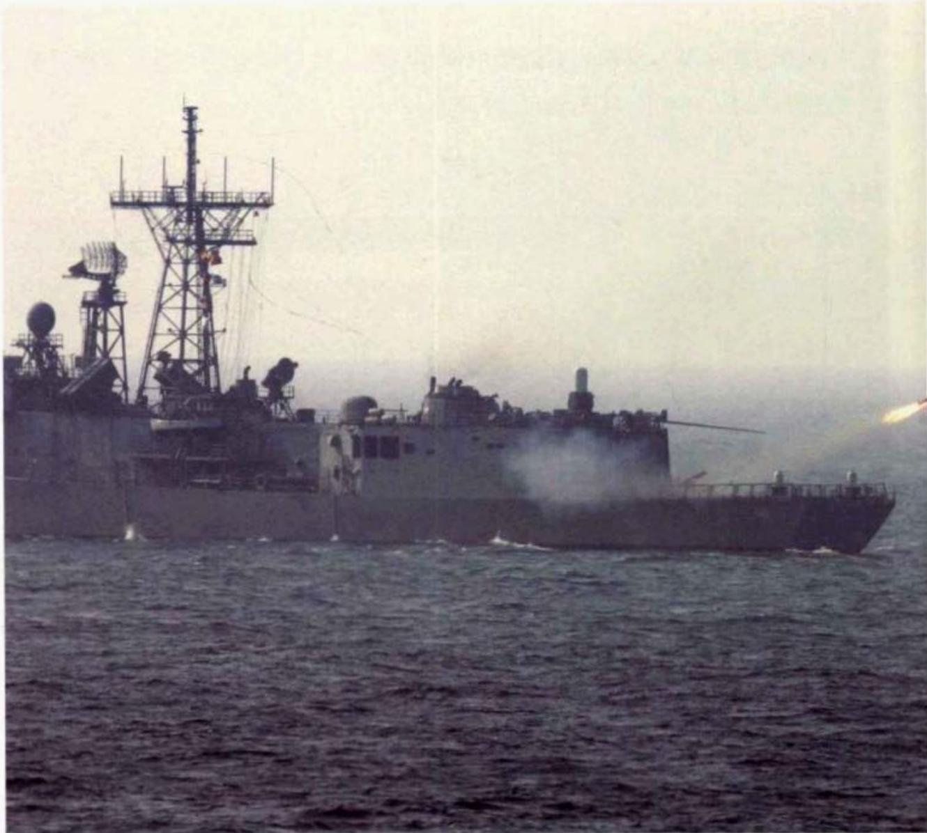
成功級巡防艦上正在施放模擬飛彈的噴射靶機，準備交由右圖的方陣快砲練習追瞄射擊。
