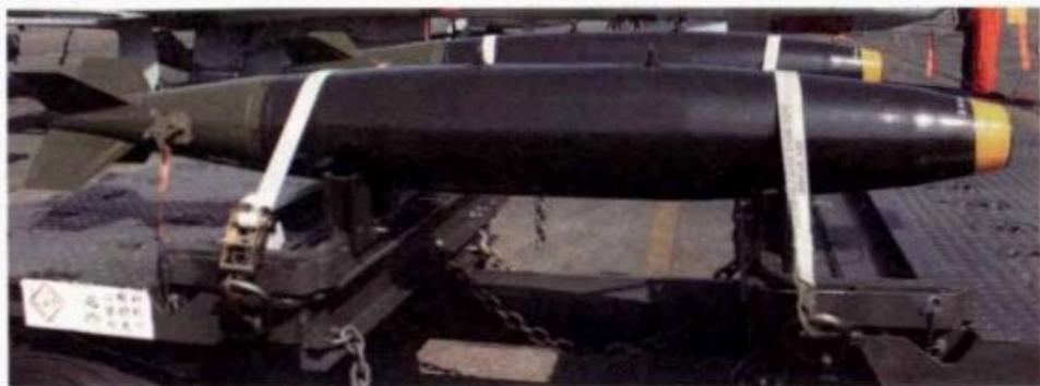
軍為了配合高速戰機飛行需求，而需要一種低阻力的空用炸彈，因此由道格拉斯飛機公司在1950年代研發出具有長徑比8：1的修長彈體、低阻力的Mk.80系列低阻力通用炸彈（LDGP）。全系列共有Mk.81、82、83、84四種，分別為250lb、500lb、1,000lb與2,000lb，經過越戰期間的大量使用後，Mk.80系列幾乎取代了美軍在此之前使用的其他型式空用炸彈，其中500lb的Mk.82更可說已成為世界上使用最廣泛的空用炸彈代表。
