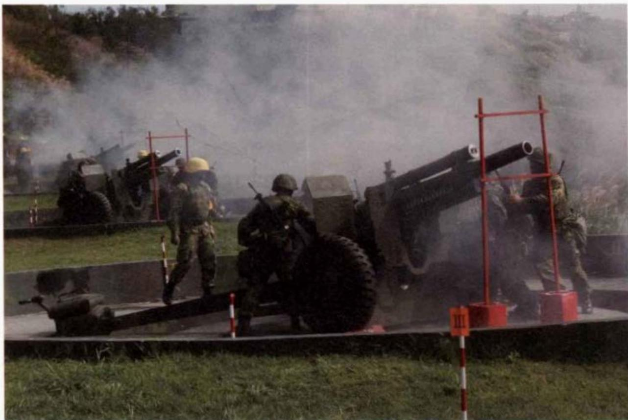
二次世界大戰後，美國將制式M2A1型105公厘榴砲重新命名為M101。韓戰後(1953年)美國以配備M2A2砲架的M101A1軍援我國，該型砲架除了原本M2A1砲架的左、右護板及上護板各1塊外，還再增加1塊底部護板及左右輔助護板，其機械式千斤頂也改為油壓式。所配備的瞄準裝備為M16A1D肘視鏡、M12A7S周視鏡，以及M4A1象限儀。
