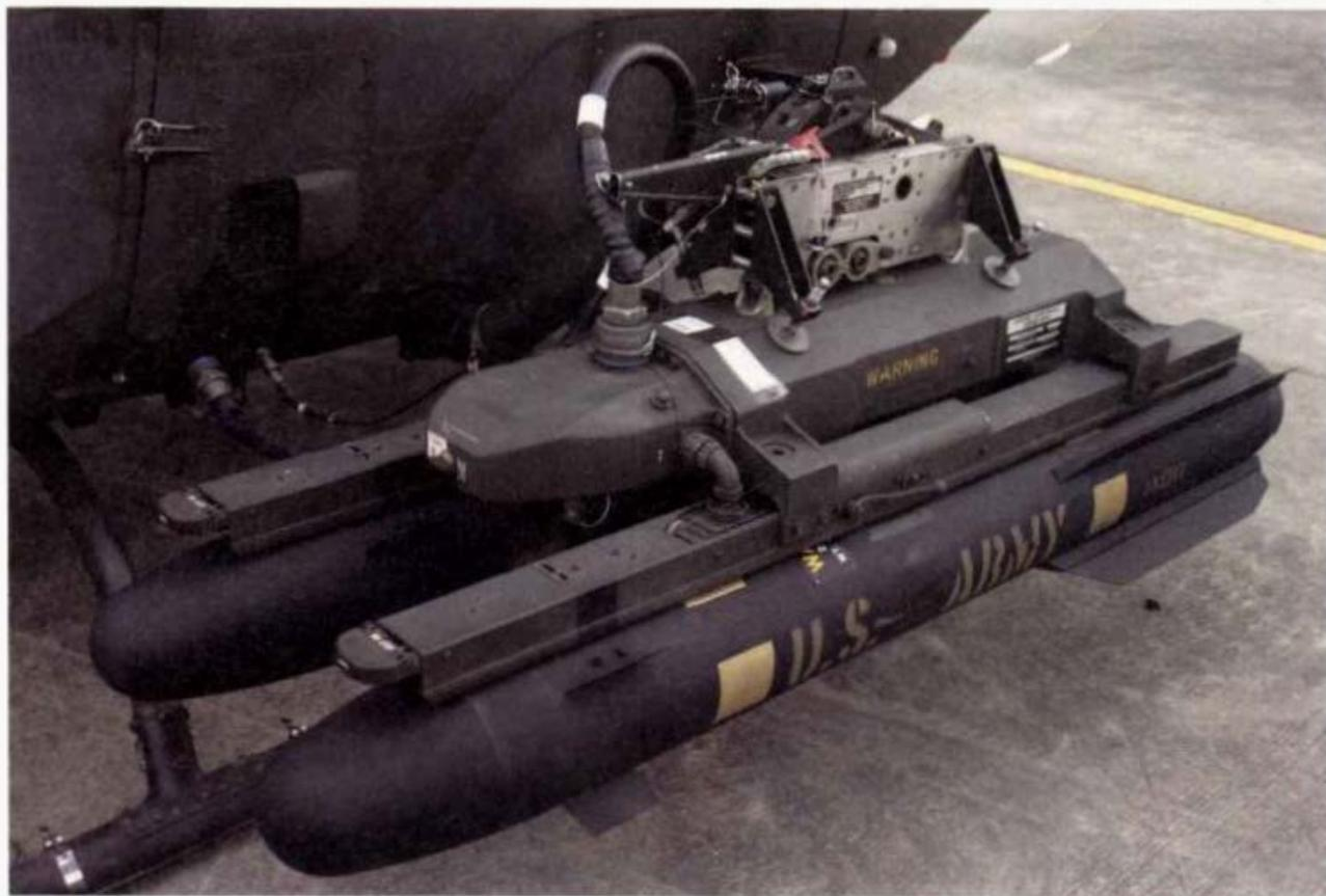
式彈頭與半主動雷射/毫米波主動雷達/紅外線影像等多重導引模式，強化其在光電反制及惡劣天候下的反反制與偵測能力，並換裝脈衝火箭發動機使其射程延伸至10km。
