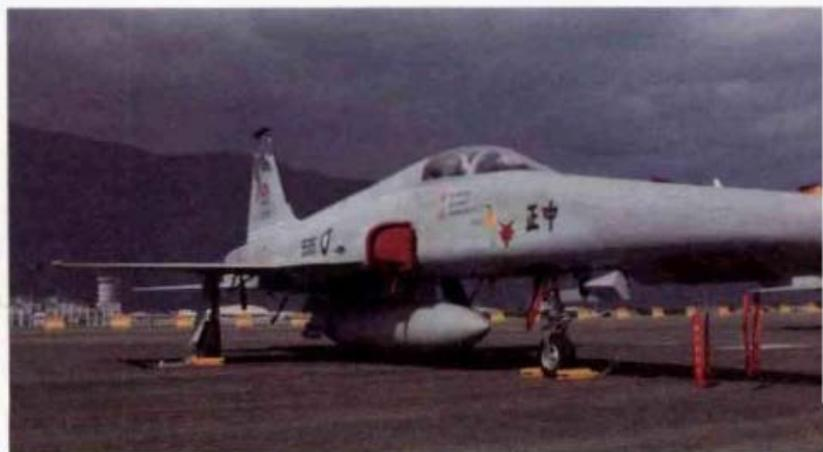
間雖不如RF-4，但藉著模組化偵照系統之設計，可以視任務需求而更換偵照模組，因此RF-5E仍具備多功能偵察能力，該型RF-5E在機首設有4個偵照艙，其中除了機鼻的前斜位置以外，其他3處都可依任務需求而更換中低空畫間、低空傾斜偵照/高空、高空垂直/長距離傾斜掃描、夜間攝影等不同任務模組。雖然諾廠宣稱：RF-5E的操作成本僅為RF-4E的60%，卻擁有RF-4E功能的90%！但最後仍然沒有改變當時我國空軍希望引進RF-4的決心。
