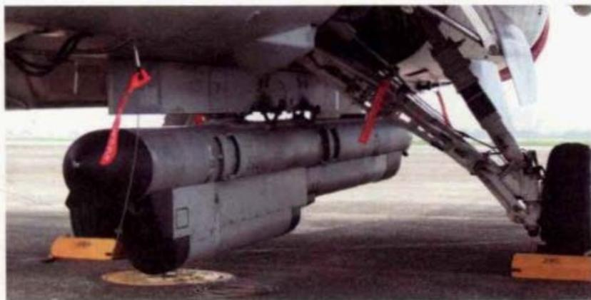
高功率干擾裝置與天線組，具有偵測、定向並分析各式雷達或尋標器的不同頻率電波，以針對其訊號自動進行雜訊干擾、反制的能力，更具備以電波直接穿透敵方雷達或飛彈尋標器的電路，破壞其計算功能的優異性能。
