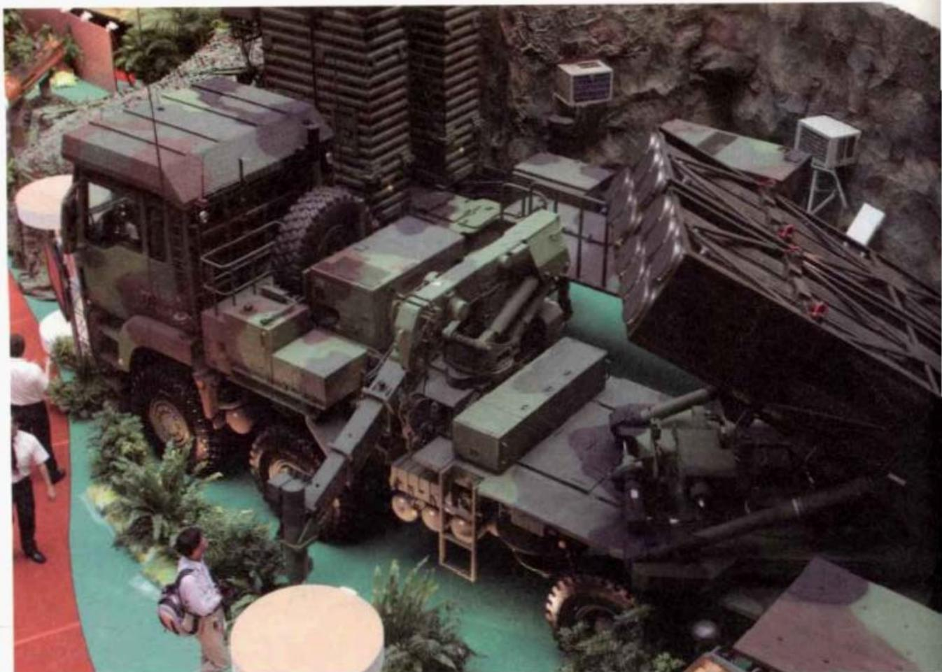
雷霆2000多管火箭系統俯視特寫，可以見到MK45火箭的彈箱已經升起，穩定車身的千斤頂則已落地。
