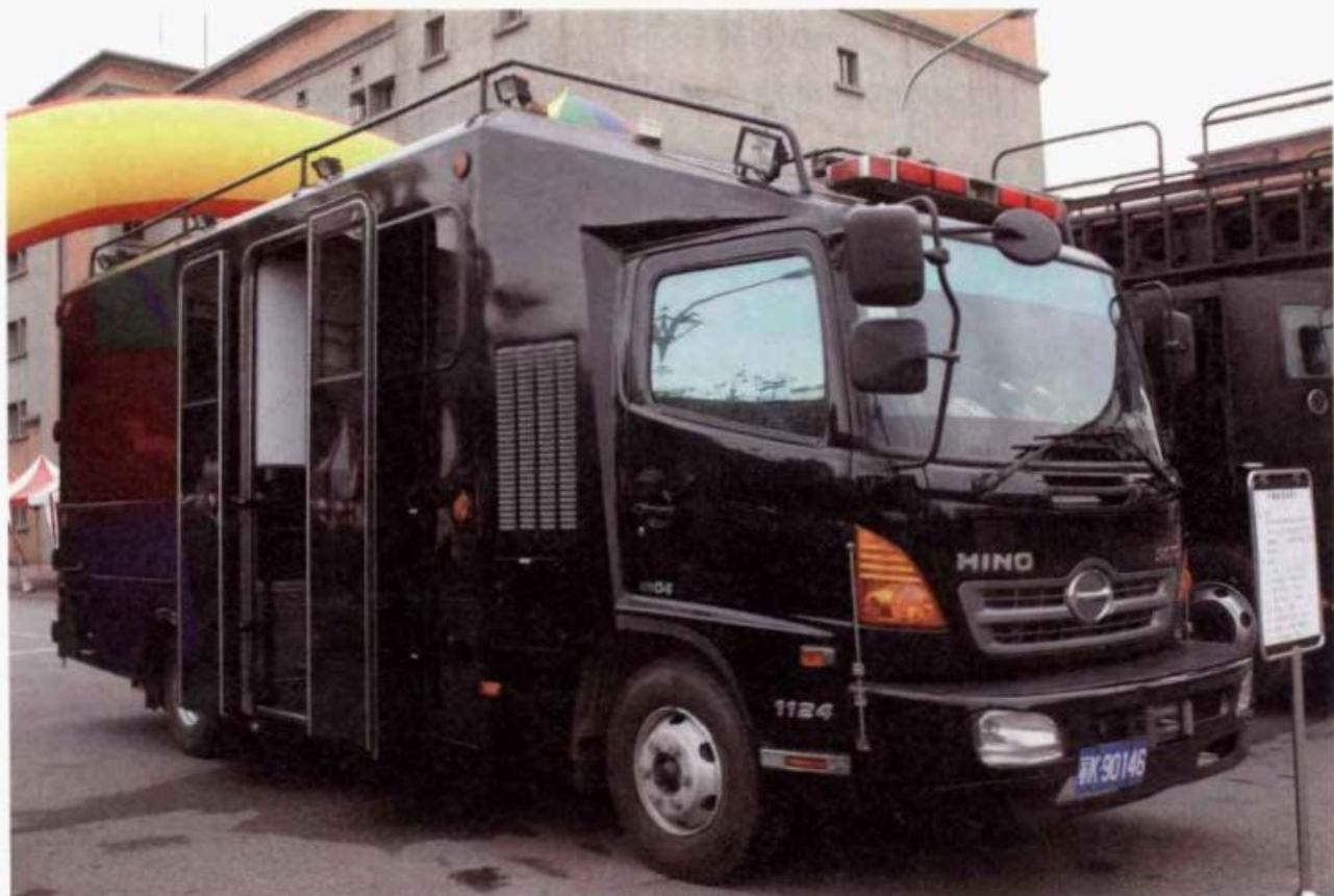
憲兵特勤隊防爆分隊配備的防爆處理車，車上搭載包括水砲、遙控攝影機等各式拆彈工具。
