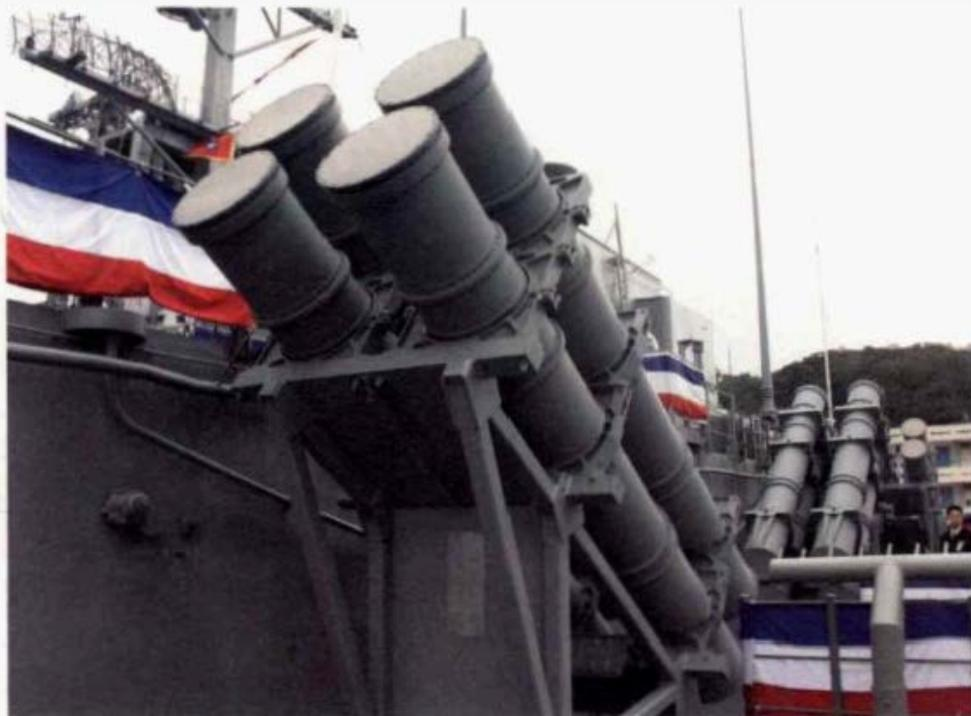
基隆級驅逐艦上配備的RGM-84L Block II魚叉飛彈裝備於該型艦上的兩座四聯裝Mk.141筒狀輕型發射器內。
