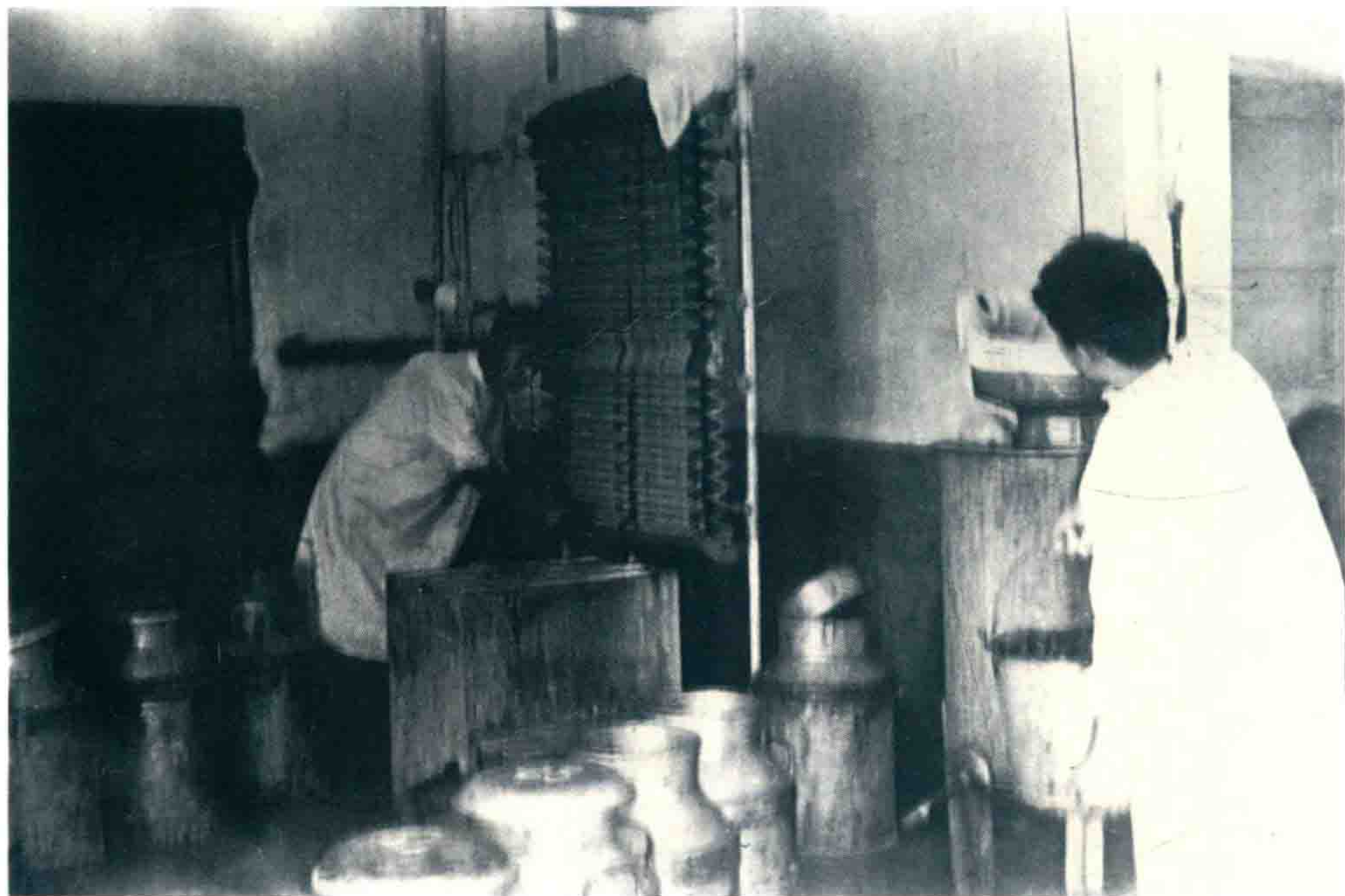
◎1957年，寒春设计的热交换牛奶冷却设备
