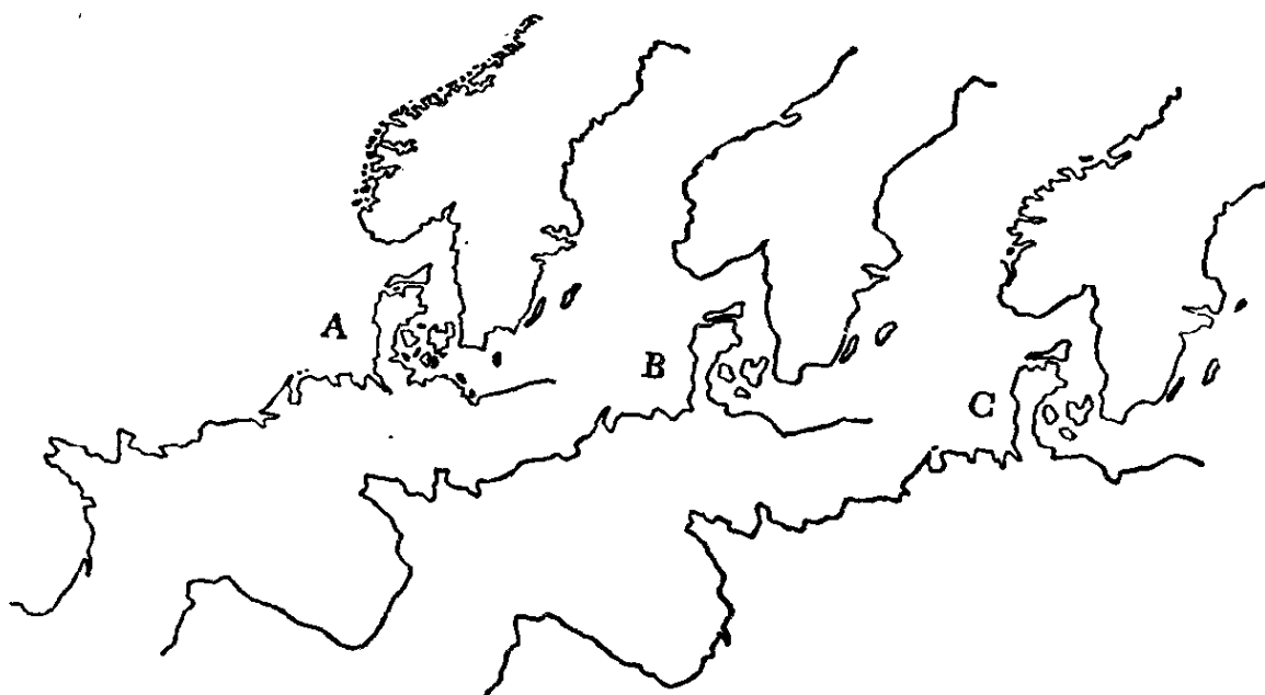
图 2.2 不同程度的制图综合
