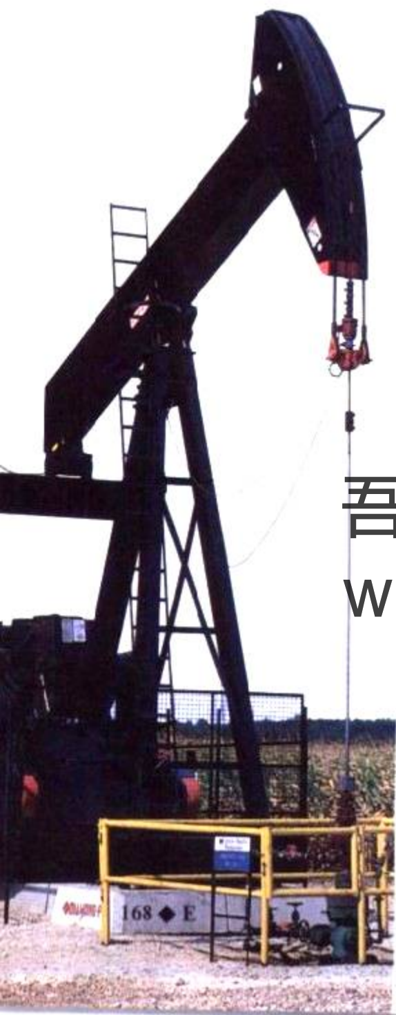
图 6-6 美国得克萨斯油井中的一个钻井台，摆锤正在来回晃动，将石油从地下抽上来。
