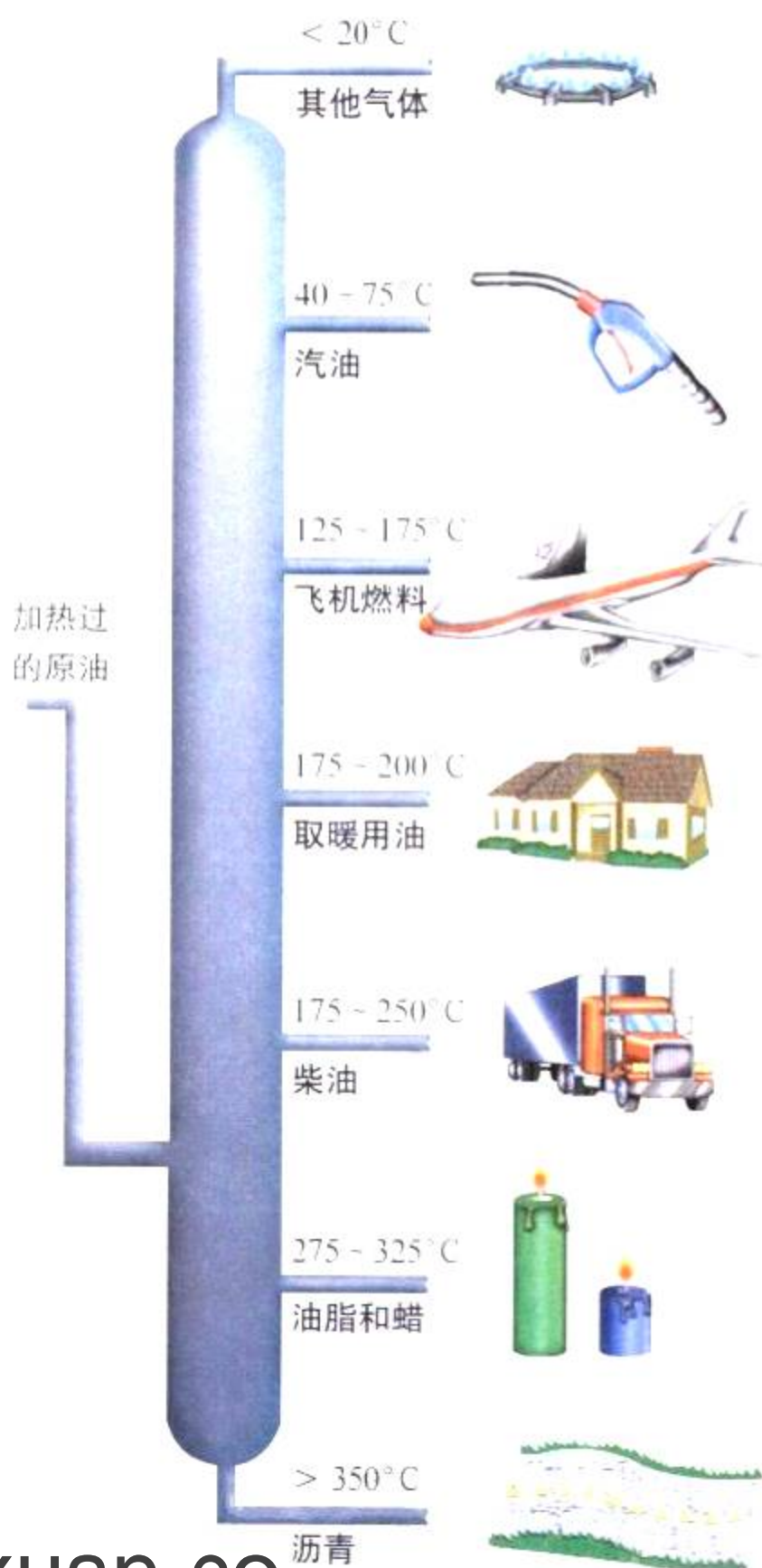
图6-7 原油经提炼后可制成许多不同的产品。在提炼中，加热使得原油中的不同物质可以相互分离，因为不同的物质有各自不同的沸点。
