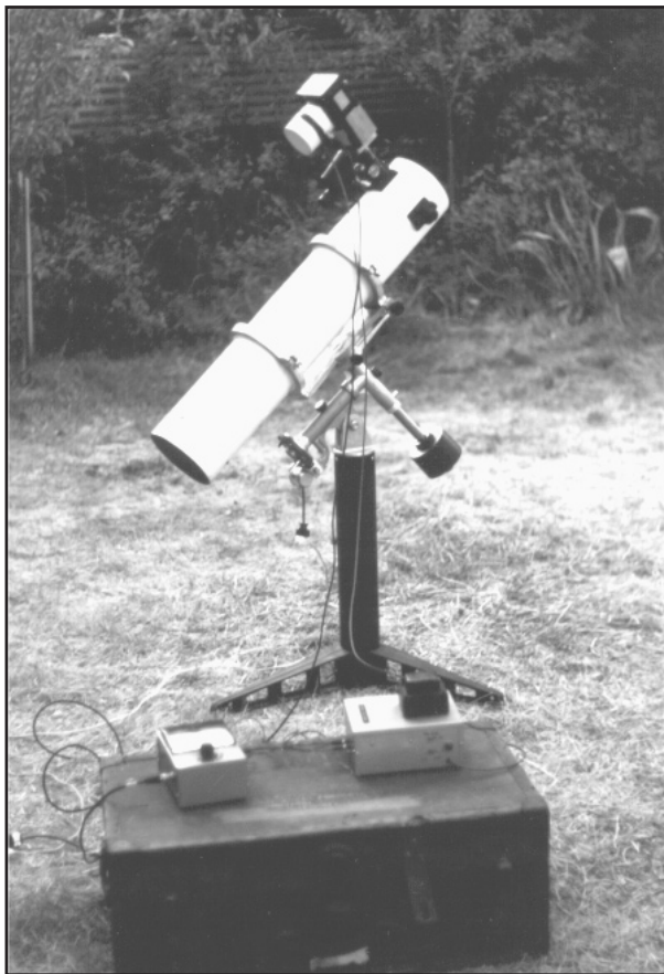
凱文克利斯希納司(Kevin Krisciunas)的6英寸反射望遠鏡和光電光度計。
