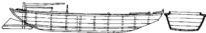
95. 漕船(线图) 元 原件于1975年在河北省磁县南开河村漳河故道一侧出土。共六只，其中五号船残长16.6米，残宽近3米，分为十一舱。
