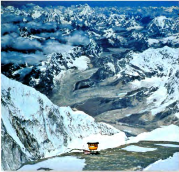
图1.23 利用GPS技术测量珠穆朗玛峰的高度 注：安装于世界最高水准点处的天宝（Trimble 4 800）GPS装置；这里只比峰顶8 844m低12m。以前这一高度被确定为8 848m。科学家利用GPS数据还精确地分析了构造作用下山脉的移动速度。
