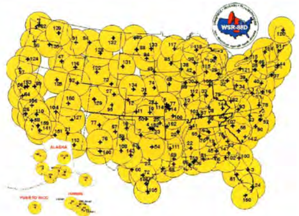
(b) 美国WSR-88D的覆盖范围，其他装置设在日本、关岛、韩国和亚速尔群岛
