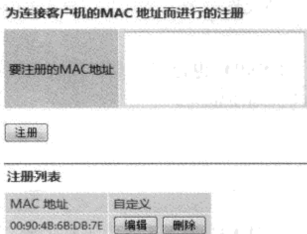
图 6-4 通过 MAC 地址对无线网络的访问进行限制
