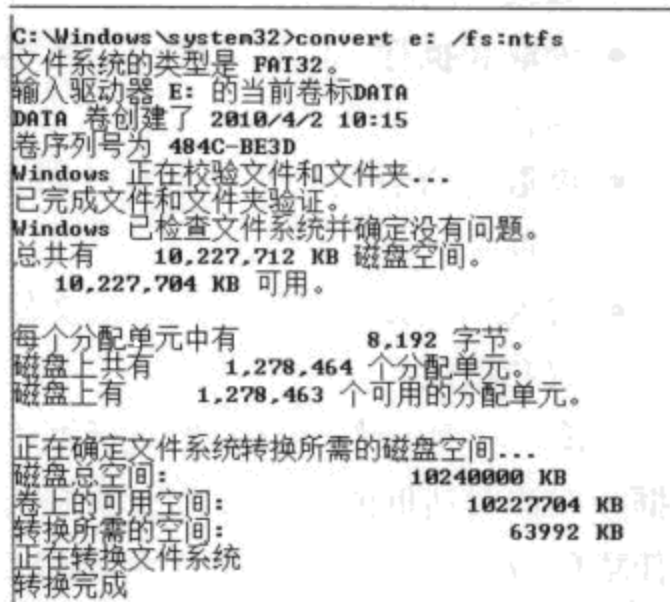
图 5-3 使用 convert 转换分区的文件系统
