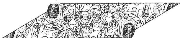
图 6.14 碘化胆甾基投影电子密度图, 每 Fourier 系数的符号选取取决于碘的贡献. 这张图也表示出了其他原子的位置
