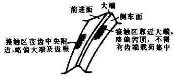
图5.12-5 标准型(N)型摆线齿锥齿轮的接触区(被动大轮齿面)
