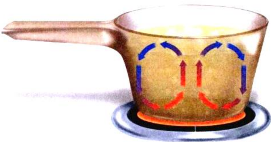
图 1-9 图中接近锅底的汤比较热,密度较小;锅表面的汤温度较低,密度较大。温度和密度的不同是发生对流循环的原因。
