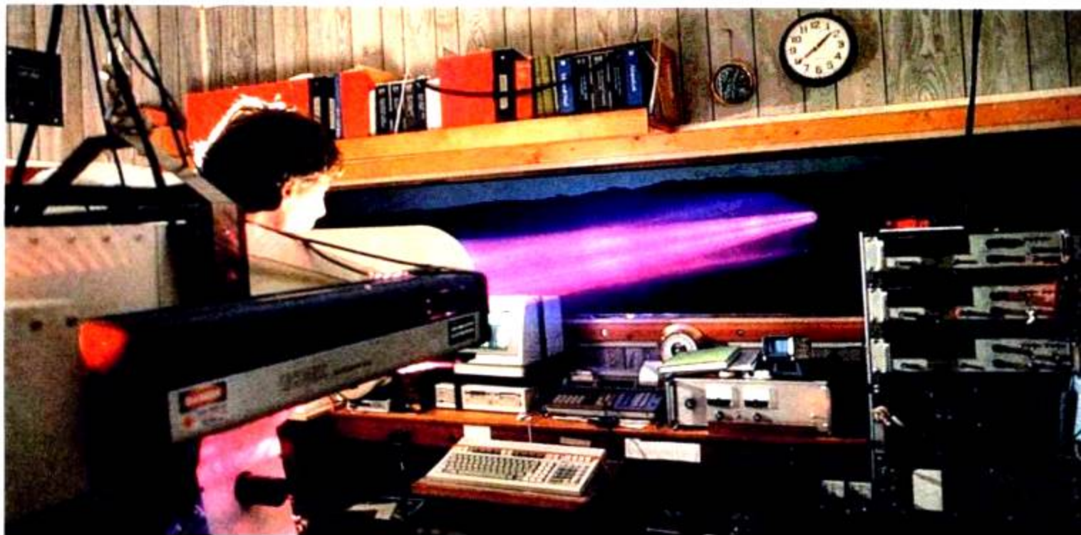
图 2-24 这个激光束用来监测加利福尼亚圣安得列斯断层的运动情况。
