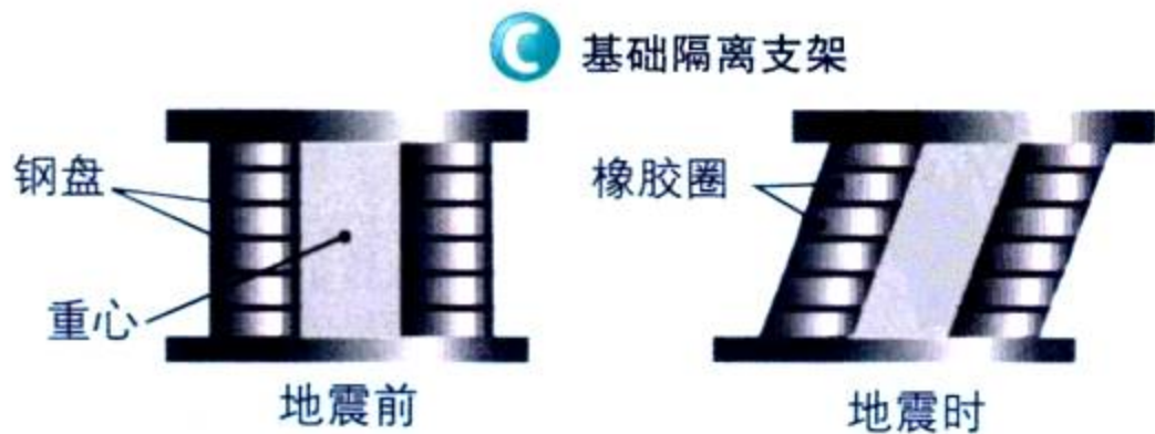
图 2-22 A.基础固定的楼房在地震中倾斜破裂。B.基础隔离楼房在地震中完好无损。C.基础隔离支架弯曲，吸收地震波的能量。
