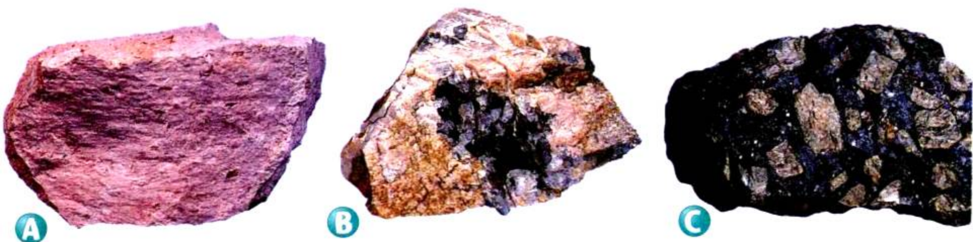
图 5-6 火成岩的结构差异较大。 A. 流纹岩是一种细粒的、矿物组成类似于花岗岩的火成岩。 B. 花岗伟晶岩是一种颗粒非常粗的花岗岩。 C. 斑岩的较大晶粒被细粒晶体包围着。
