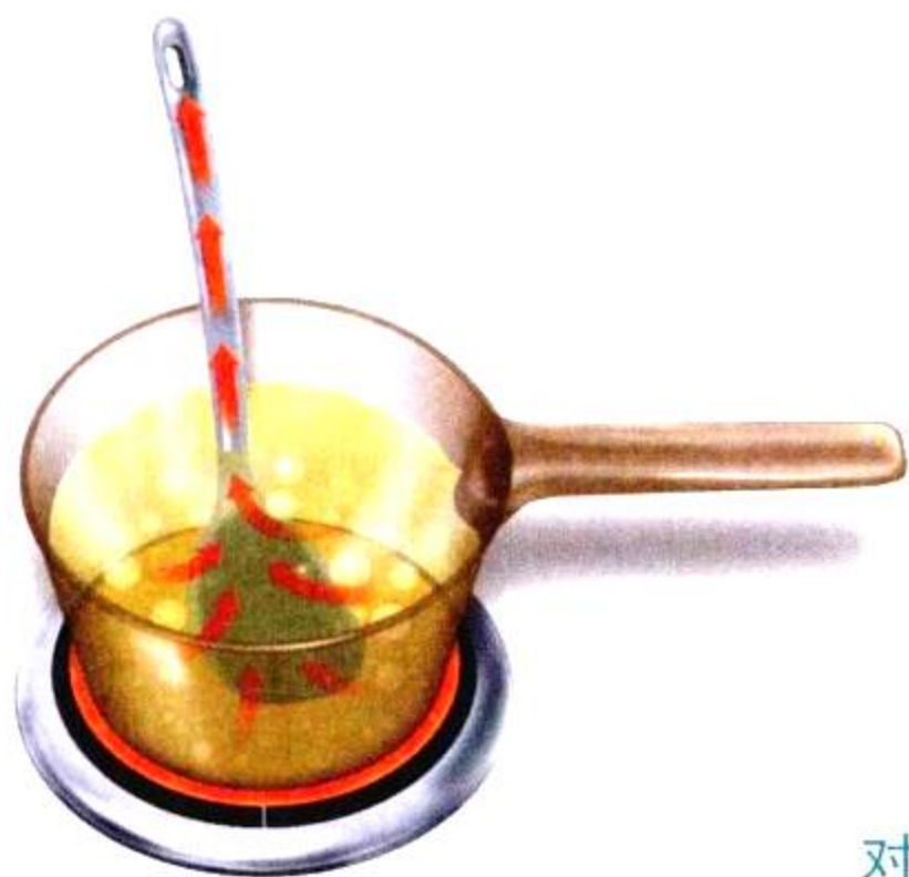
图 1-8 物体被加热后,物体间通过分子的直接接触传递热量。图中调羹和锅子就是这样被加热的。
