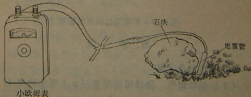
第18图 用小欧姆表检查电雷管
