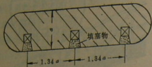
第61图 装药设置在桥墩厚度1/3深药洞中
