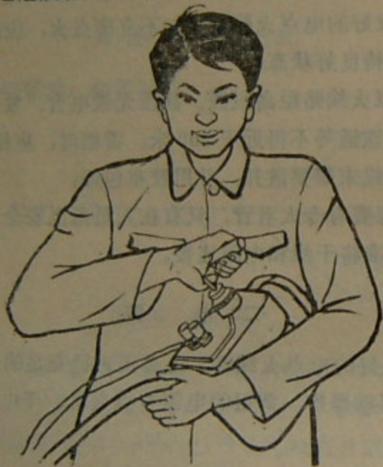
第36图 25发点火机使用方法
