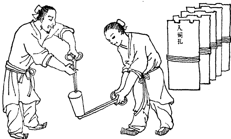
图七九 提取熔罐铸钱图
