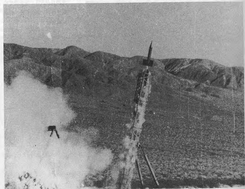
小卒A飛彈成功試射的照片；該飛彈是美國研發出的第一枚以固態燃料推進的飛彈。 圖片提供：NASA/JPL
