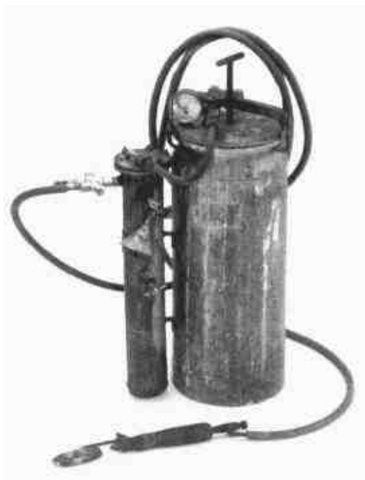
带有焊铁的乙炔或称电石气发生器
