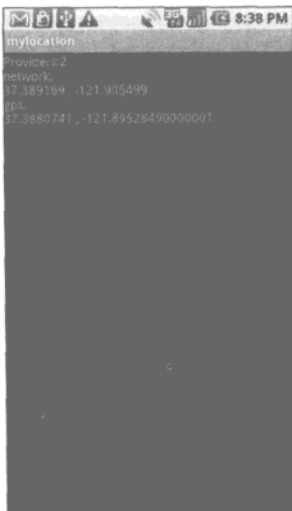
图10-1 在一个真实的Android设备中显示的所有可用位置提供者以及它们的lastKnownLocation
