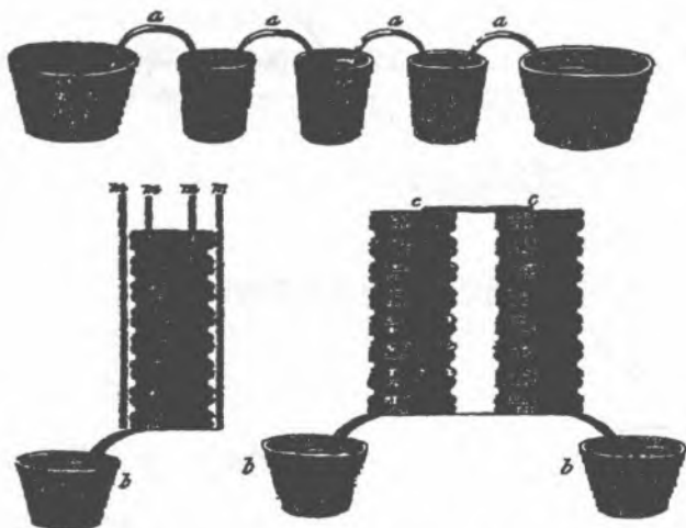
图 8.10 图的上半部分为伏特的“杯冠”,下半部分为伏特的电堆
