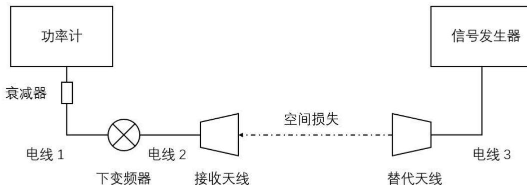
图 C.1 校准装置
