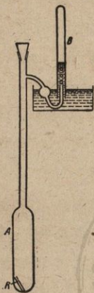
第 166 圖 Victor Meyer 氏之汽密度測定法。
