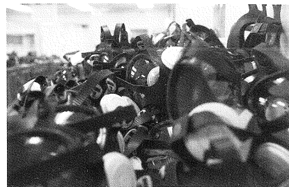
全罩式面具在確認放射性物質污染程度後，先擦拭表面，再更換過濾器，然後才回收再利用。
