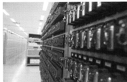
受到系統性管理的大量APD（個人輻射劑量警報器）。男性配戴於胸口，女性配戴於下腹部。
