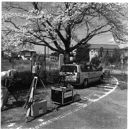
使用 3D 雷射掃描儀、無人機、車載移動式 3D 觀測儀器記錄城鎮的風貌。(照片提供：遠藤秀文)
