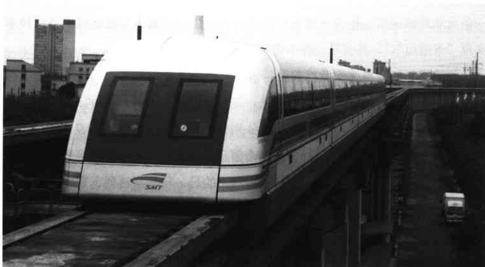
基于德国常导磁悬浮技术的上海磁悬浮高速列车。
