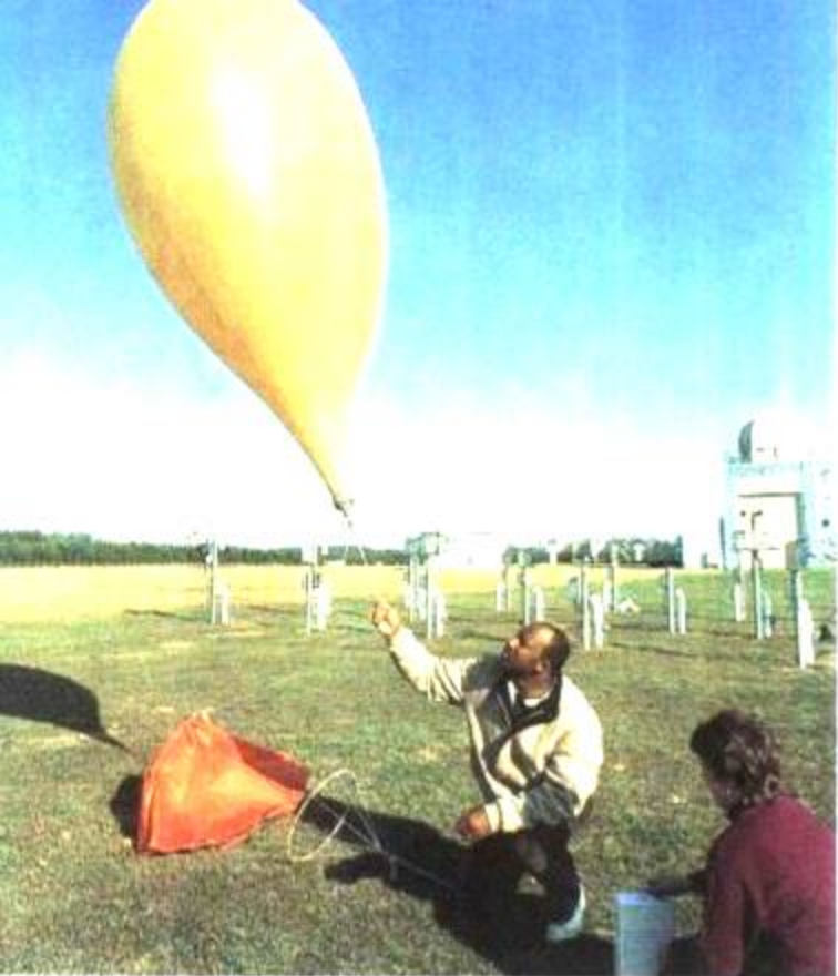
图 1-13 气象气球装载着一包用以测量高空天气状况的仪器。
