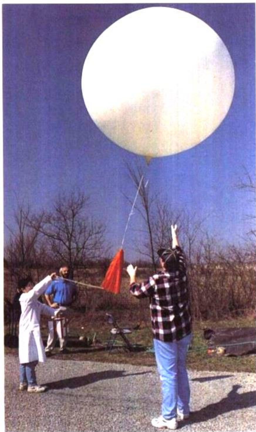
图 3-17 气象学家正在放飞一个气象气球。系缚在气球上的盒子里装有能记录气象资料，如温度、气压和湿度的装置。
