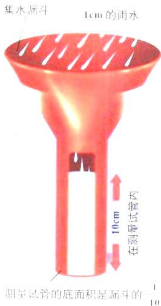
图2-20 雨量器用来测量降水量。
