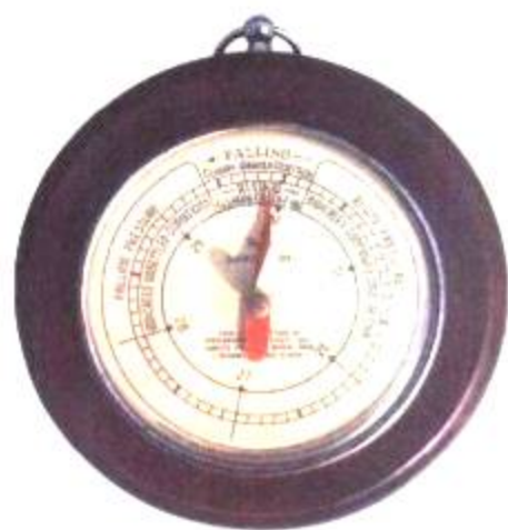
图 1-11 气压的变化使密封金属体薄壁凹进或凸出。刻度盘上的指针显示气压的大小。
