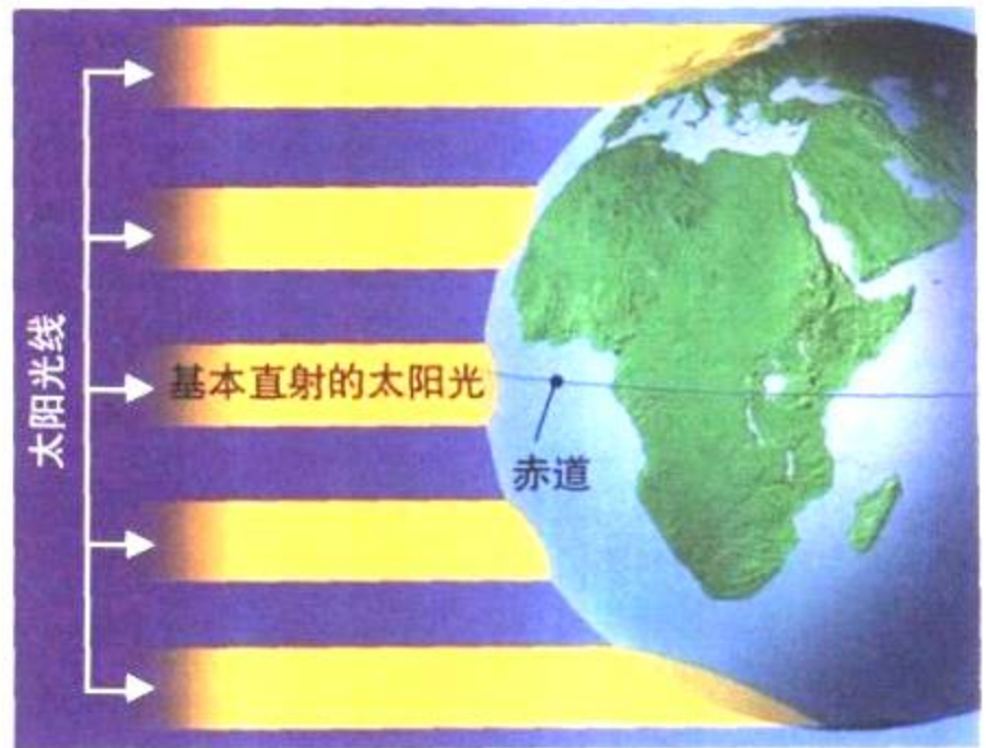
图2-9 在赤道附近，太阳能几乎直射在地球上。而在两极附近，相同的能量被散布到一个较大的区域。
