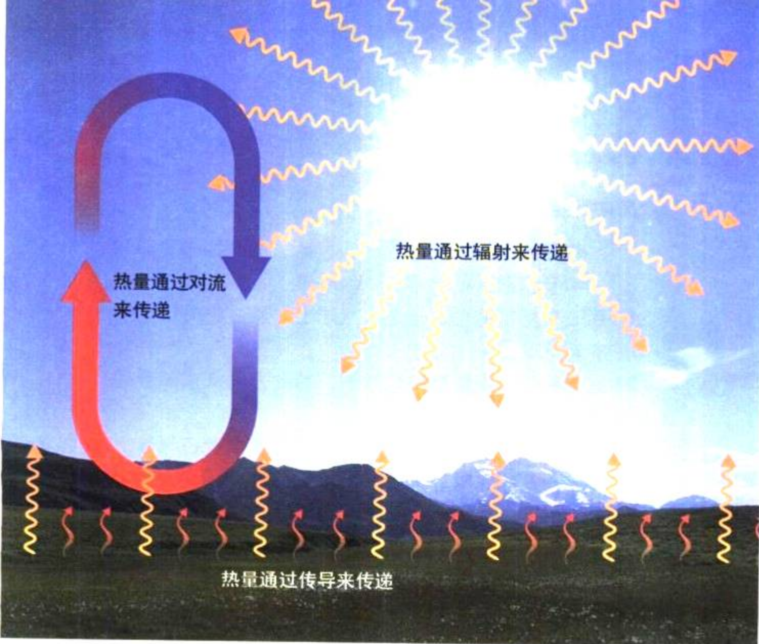
图2-5 热量传递的三种方式——辐射、对流和传导(在近地面发生)。
