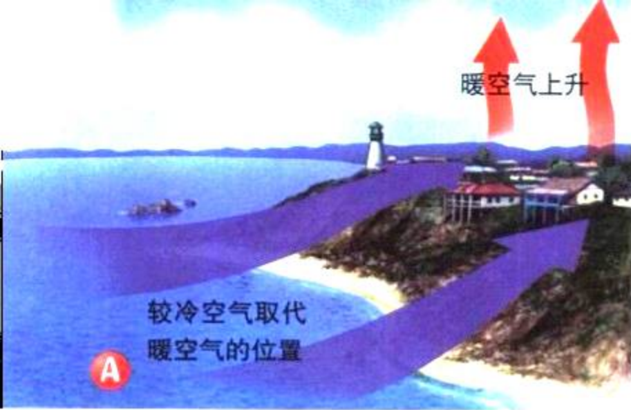
图2-7 A. 白天, 较冷空气从海洋向陆地移动, 形成海风。 B. 晚上, 较冷空气从陆地吹向海洋, 形成陆风。
