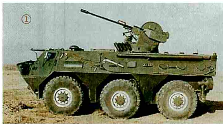
如果我们把早期定型的WZ551式和TPz-1做一个简单对比的话，就会发现WZ551式轮式装甲车(①)从外观到构造，乃至技术总成都和TPz-1“狐”(②)有着惊人的血缘关系
