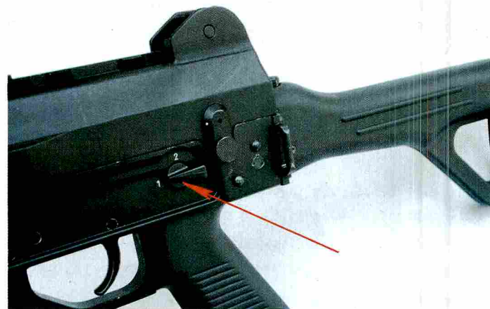
03式下机匣左侧特写。箭头所指处为快慢机扳手，其形状和81式步枪完全相同
