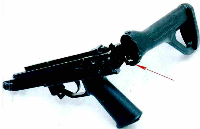
03式下机匣尾部和折叠枪托部分。箭头所指处为枪托卡笋头部的位置
