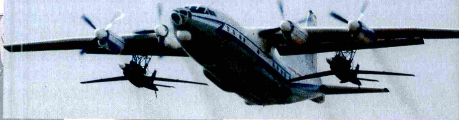
1架运8运输机可挂载并放飞2架“无侦”5高空侦察机
