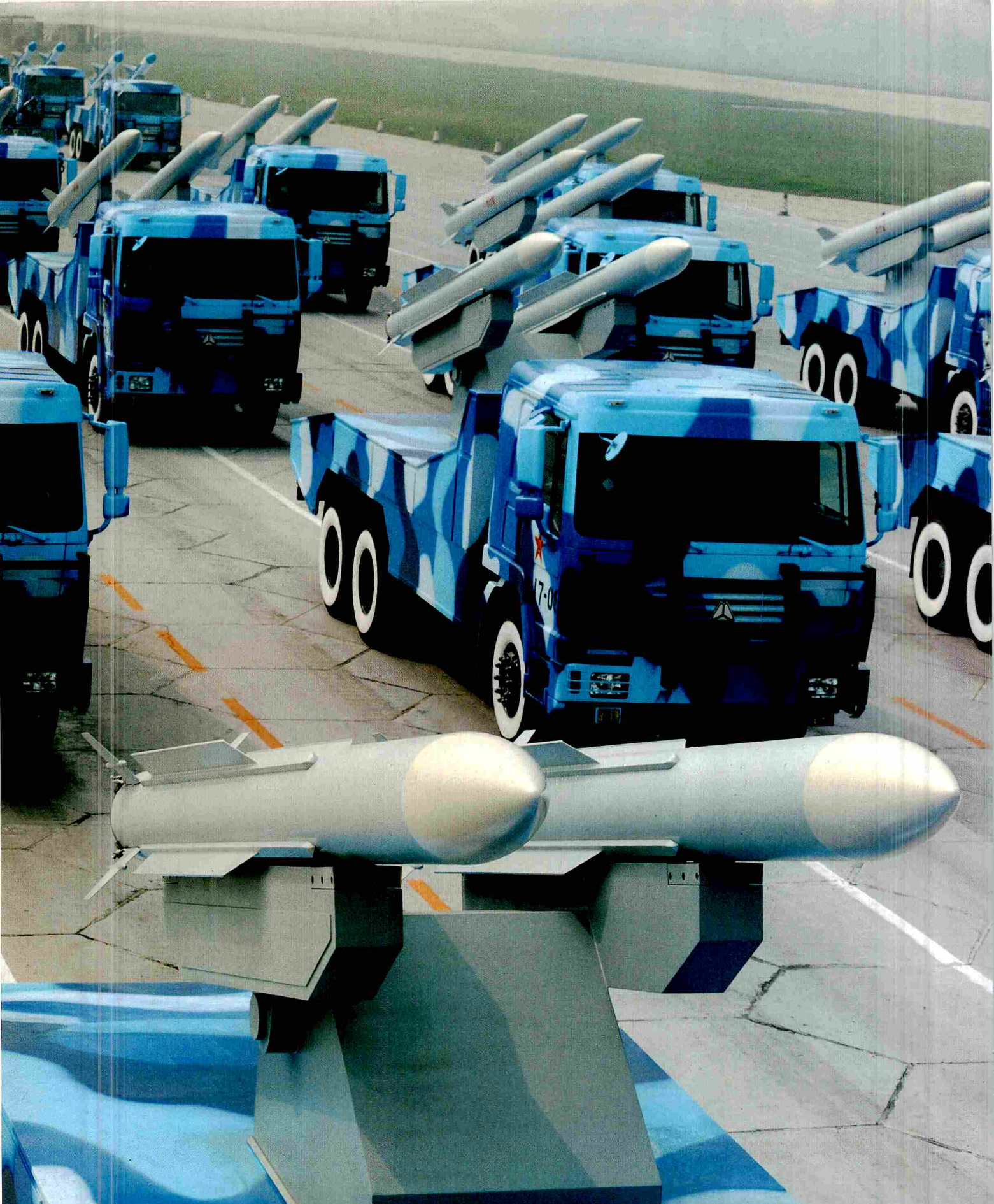
“海红旗”-16/“海红旗”-9舰空导弹 “海红旗”-9远程舰空导弹系统（图上部），采用先进的捷联惯导/指令修正+末段主动雷达的制导体制，导引头抗干扰能力强，是一种全天候、全空域的远程防空导弹系统。“海红旗”-16舰空导弹（图下部）采用终端半主动雷达导引，有效射程3~55公里，配备4部MR90火控雷达，可以同时引导8枚导弹迎击空中目标。
