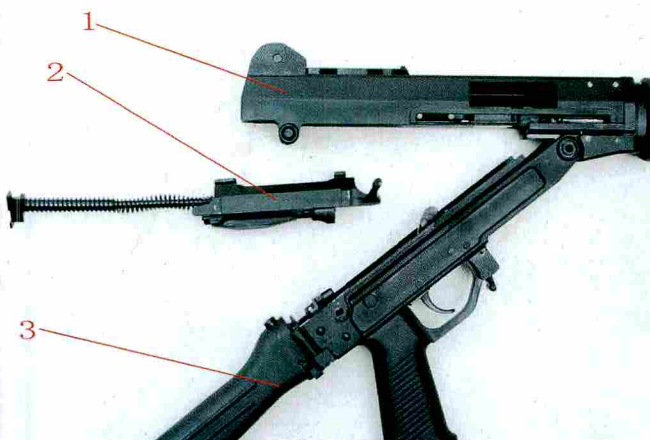
上下机匣打开、取出枪机和复进机系统的03式步枪。图中1为上机匣，2为枪机复进机系统，3为下机匣组件
