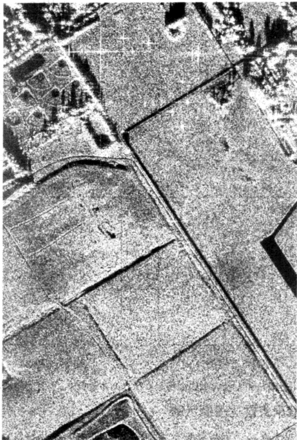
图 8.15 用 \omega KA 处理的一幅 X 波段机载聚束 SAR 图像 (由 MacDonald Dettwiler 提供)
