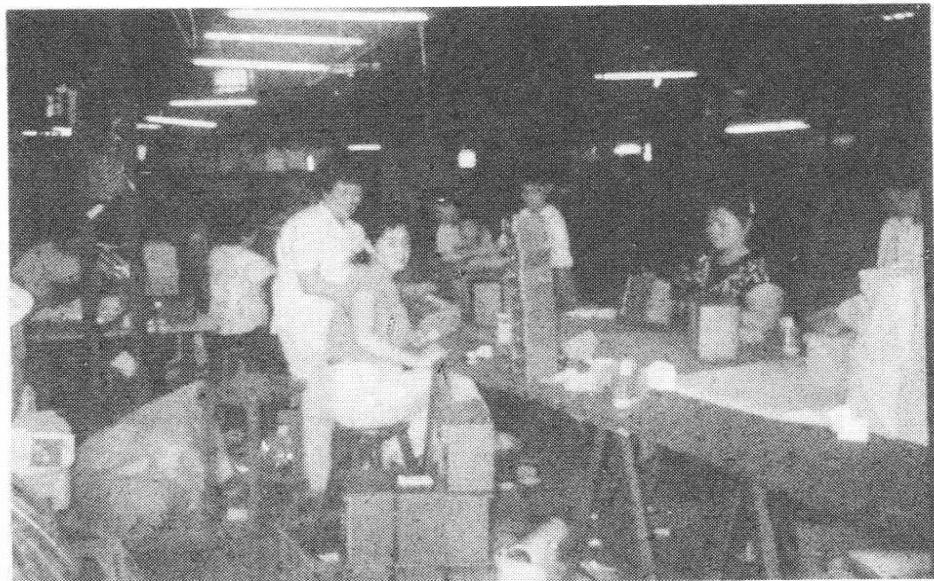
预先组合好的抽屉、门、箱身、音乐铃最后在这个组合工厂组合成木制珠宝箱，经过外商代理验收后，装箱出口。组合工厂是卫星工厂中雇有最多工人的工厂。
