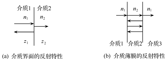
图 4.21 介质界面和介质薄膜层反射特性示意图
