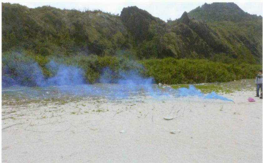
風速不足且以陣風方式吹送的煙霧，在陣風之間隙煙霧往上擴散，形成上下震盪，且往後擴大煙流幅的現象。(海參坪：2014.11.9)
