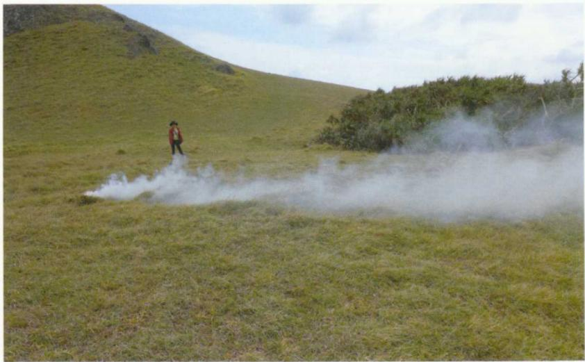
在微升地形，原應平行水平面的煙霧被迫沿地形前進，但因地面磨擦作用，煙霧必然順時針方向打滾。(牛頭山：2014.11.9)
