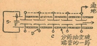
圖 33 加速管的構造。
