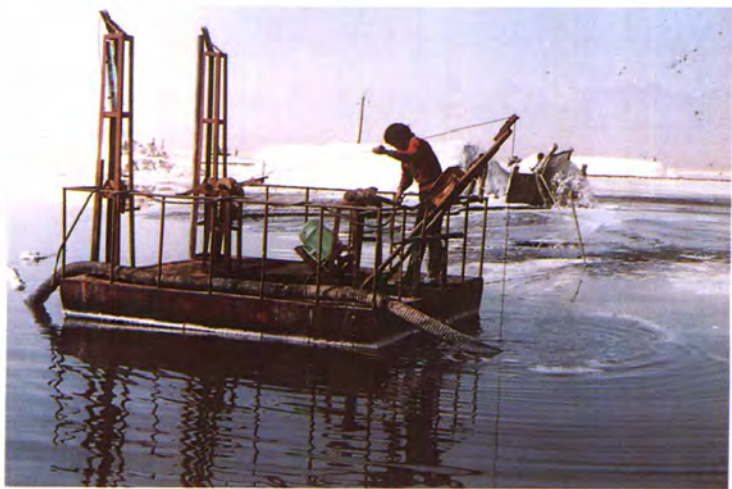
22 青海省茶卡盐场自制轻型采盐船开采再生盐。 (青海省盐业公司供稿)
