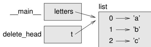
图 10.5: Stack diagram.
