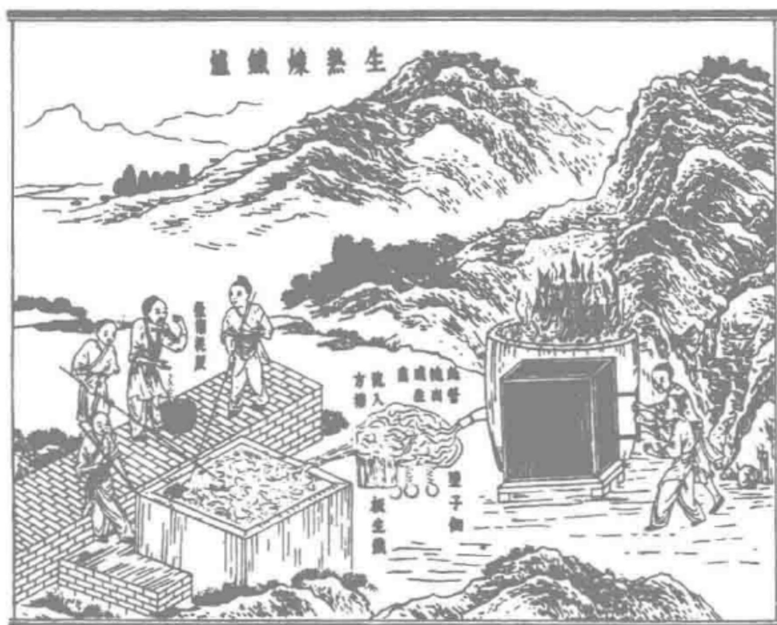
图 16:传统鼓风炉的操作情形,显示了双动式活塞风箱(这里是用手操作的),生铁的流出,以及在平台上用硅土将生铁转变为熟铁。此图出自《天工开物》。
