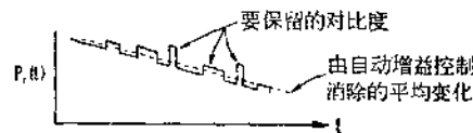
图 8.10 示出自动增益控制问题性质的在农业区单个脉冲回波的例子
