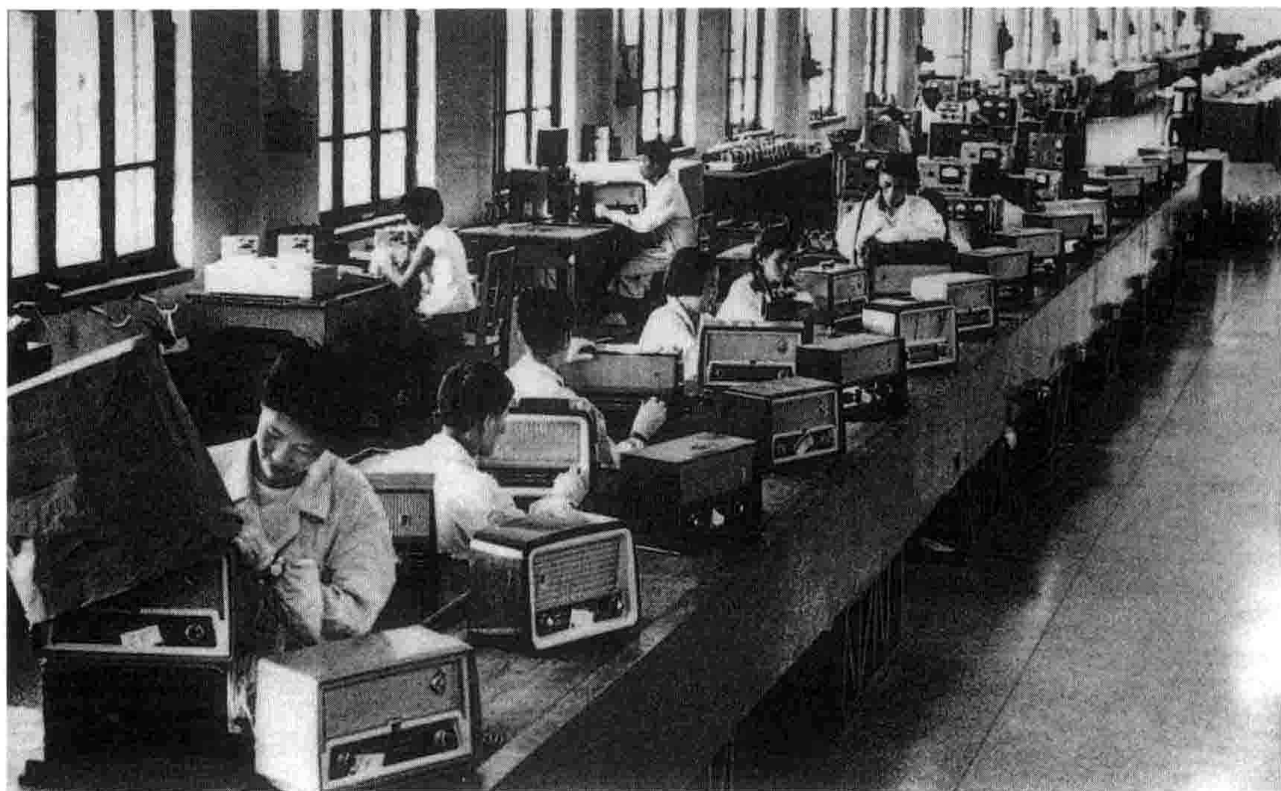
◆ 南京无线电厂工人在检验熊猫牌电子管收音机的质量
