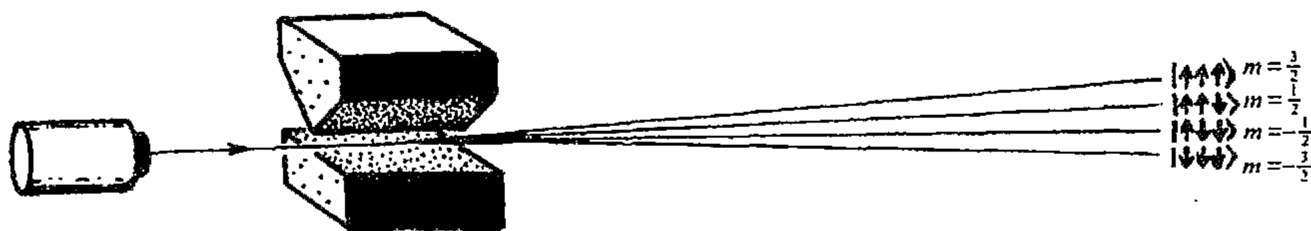
图 22.15 用来测量原子磁矩“ m ”值(耦合了自旋)的施特恩-格拉赫实验仪。当原子通过一个极不均匀的磁场区时,每个 m 值的原子的径迹都会发生稍许不同的偏转。
