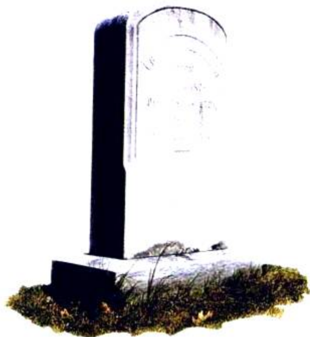
图 2-3 墓碑的风化速率取决于不同的岩石类型。板岩(上图)抗风化性比大理石(下图)好。
