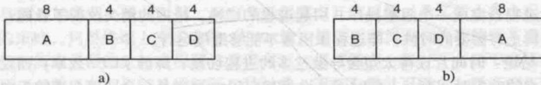
图2-41 最短作业优先调度的例子：a) 按原有次序运行4个作业；b) 按最短作业优先次序运行
