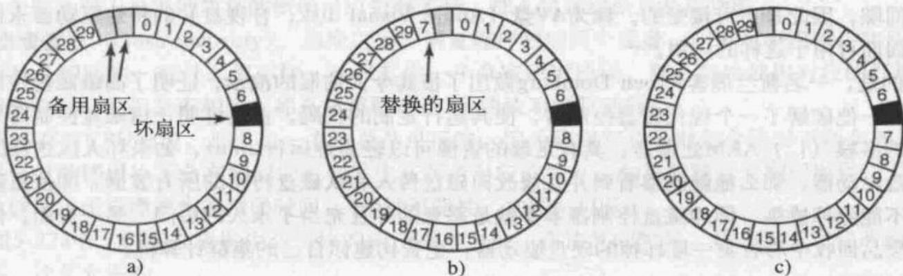
图5-26 a) 具有一个坏扇区的磁盘磁道；b) 用备用扇区替换坏扇区；c) 移动所有扇区以回避坏扇区
