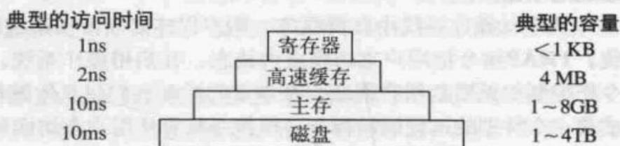
图1-9 典型的存储层次结构，图中的数据是非常粗略的估计
