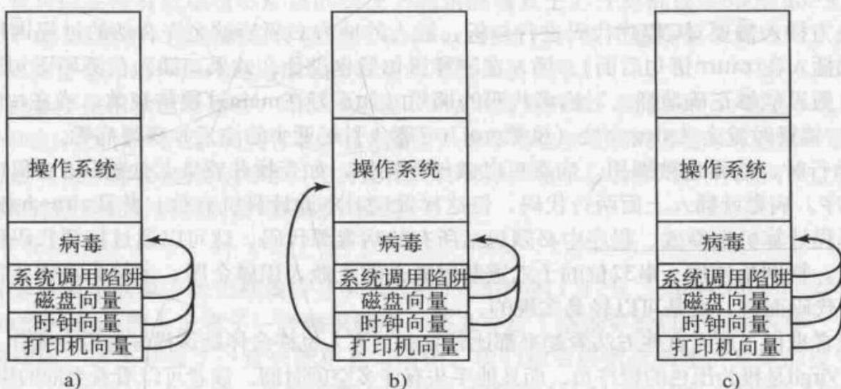
图9-30 a) 病毒捕获了所有的中断向量和陷阱向量后；b) 操作系统夺回了打印机中断向量；c) 病毒意识到打印机向量的丢失并重新夺回了控制权
