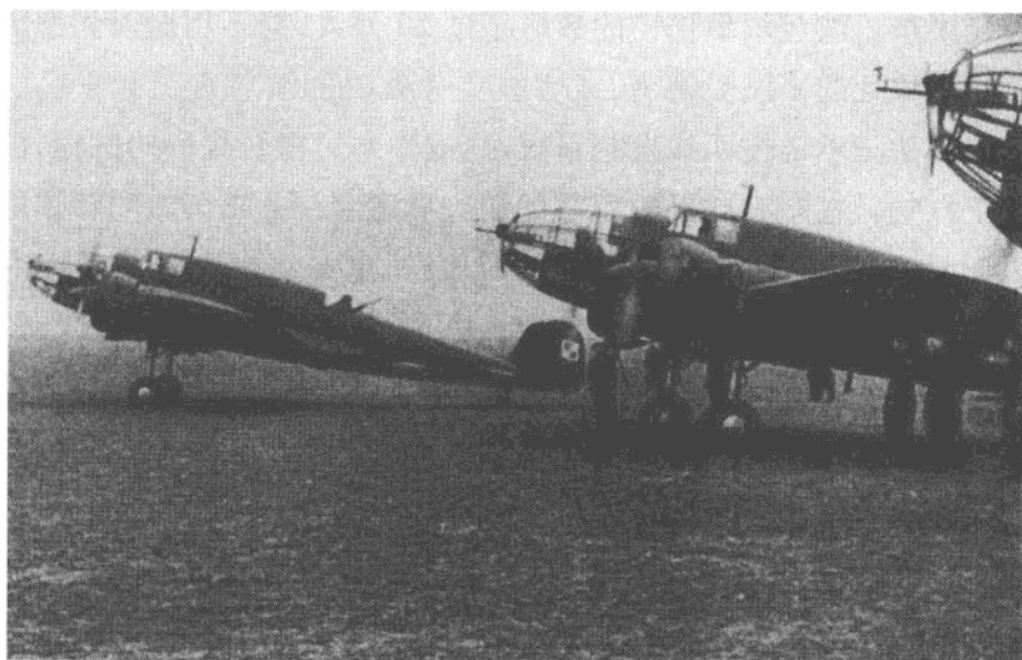
图 44 波兰当时技术水平最先进的轰炸机 PZL P. 37 Łoś(‘Elk’)。其最高时速可以达到 277 m. p. h., 射程为 932 公里以及 4 850 磅的炸弹携带量,它可以与世界上任何国家使用的最好的中型轰炸机进行比较。但是波兰人只有太少的现代化飞机来面对 1939 年纳粹和苏联的冲击。在 1936 年至 1939 年间它只制造出 180 架这样的飞机。战后,它的设计师耶尔齐·东布罗夫斯基(Jerzy Dąbrowski)在英国和美国从事飞机制造工作。
